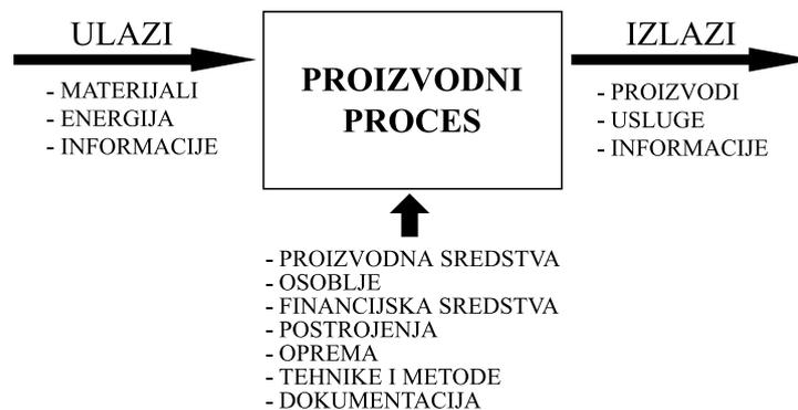
Slika 2.2. Shematski prikaz proizvodnog procesa [2]
