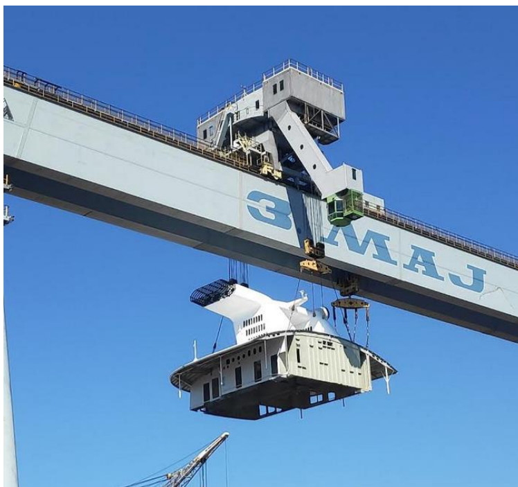
Slika 2.4. Montiranje VT sekcije na brod
