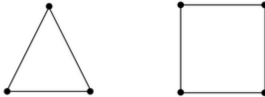
Slika 6.2. Trokutasti i kvadratni plošni element
