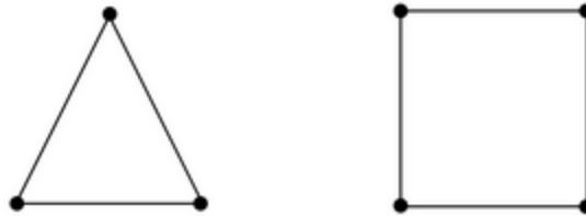
Slika 6.2. Trokutasti i kvadratni plošni element
