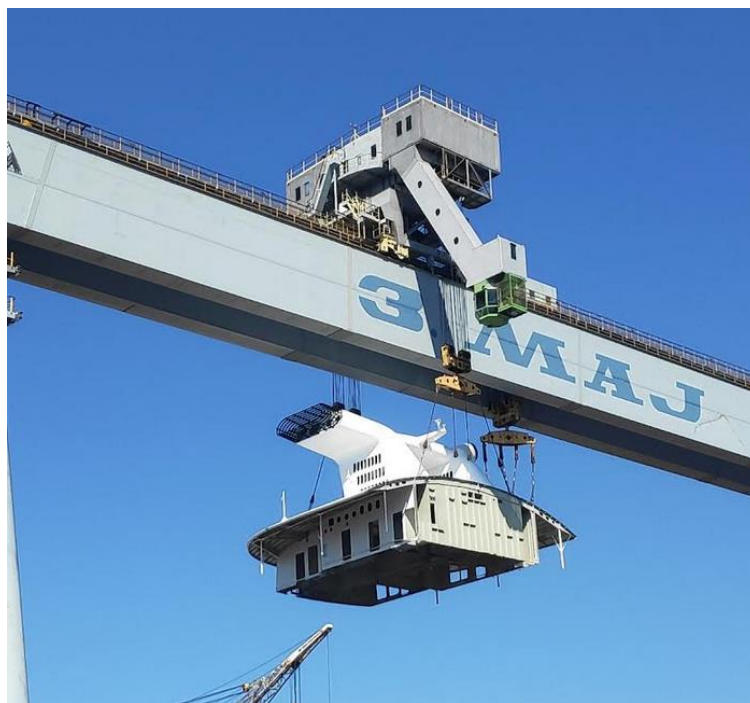
Slika 2.4. Montiranje VT sekcije na brod
