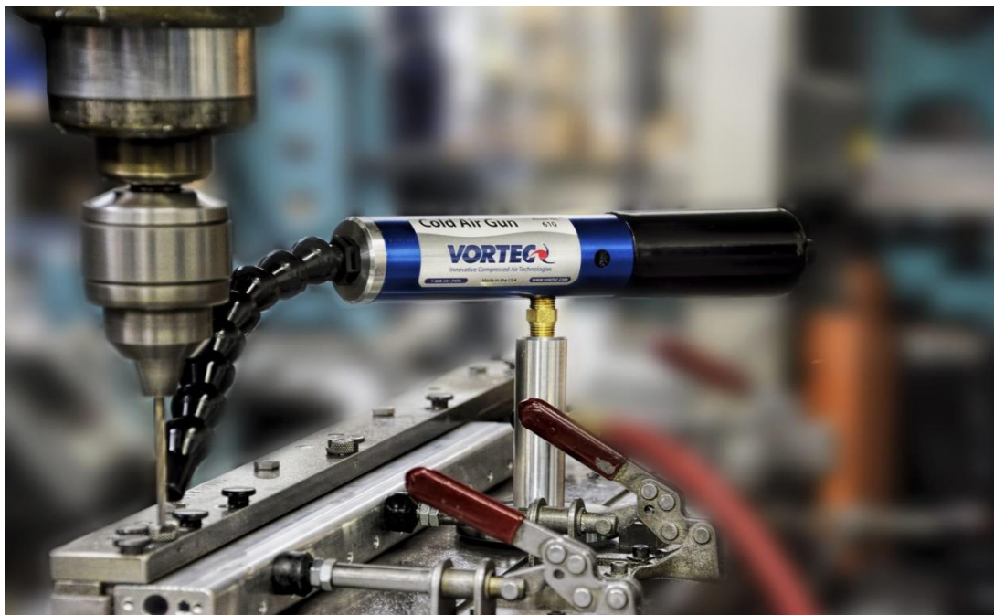
Slika 4.9. Primjena vrtložne cijevi u industriji [40]
