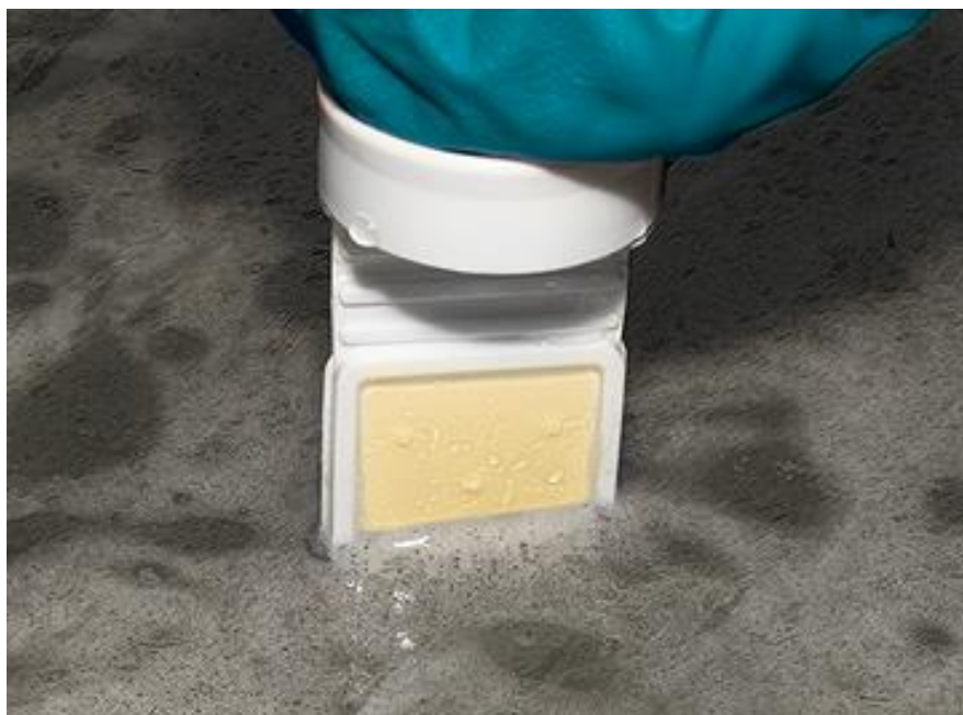
Slika 3.2. Uređaj za ispitivanje razine kontaminacije i pH vrijednosti SHIP-a [16]
