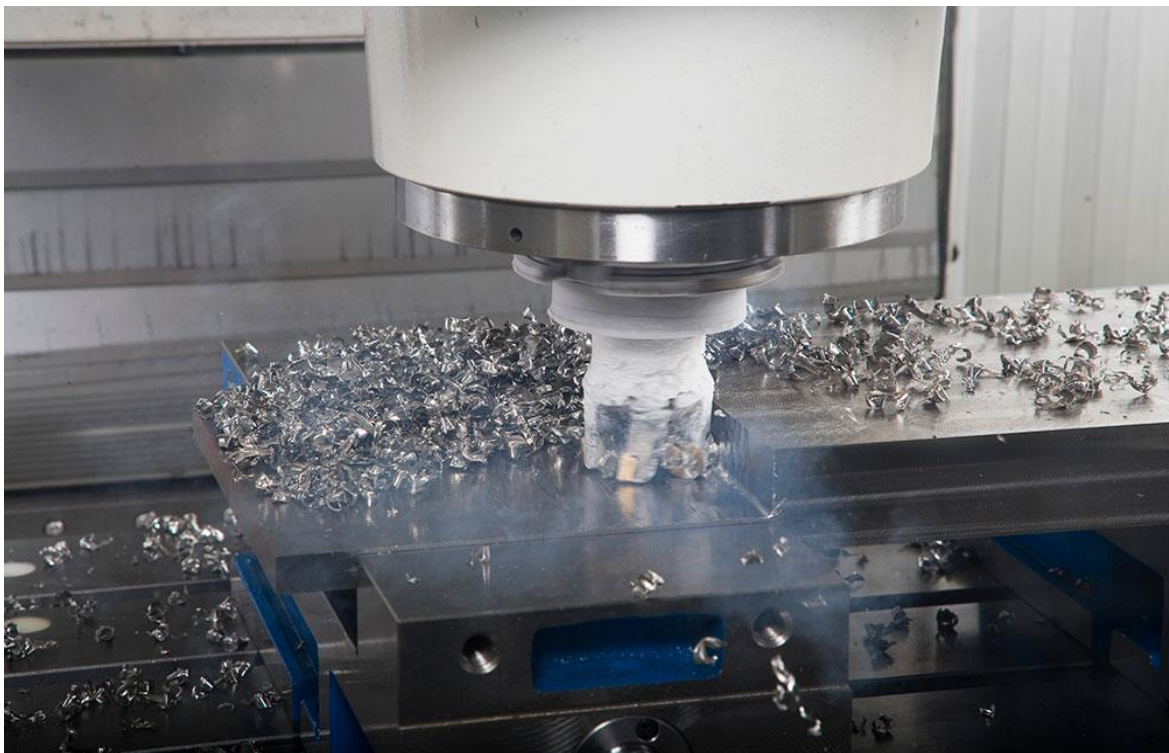
Slika 4.5. Kriogena obrada glodanjem [31]
