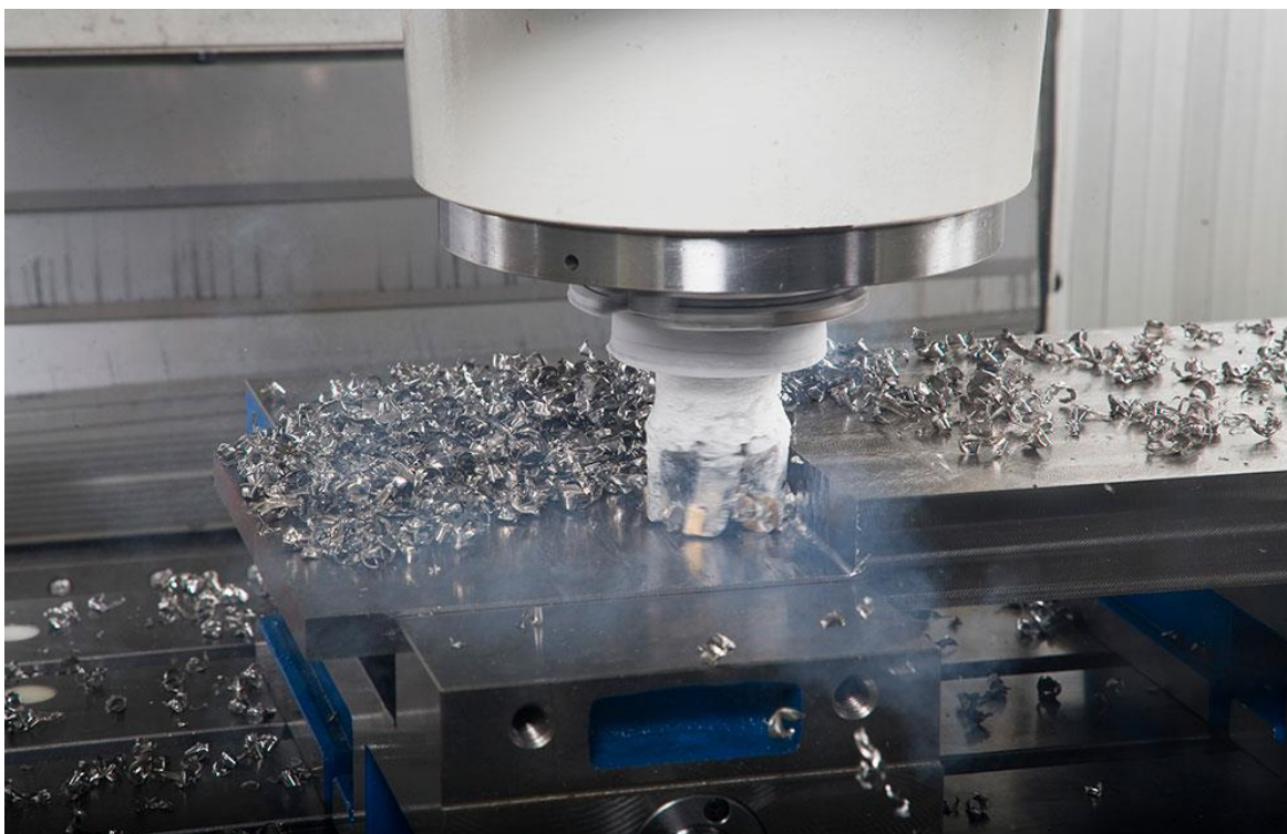
Slika 4.5. Kriogena obrada glodanjem [31]
