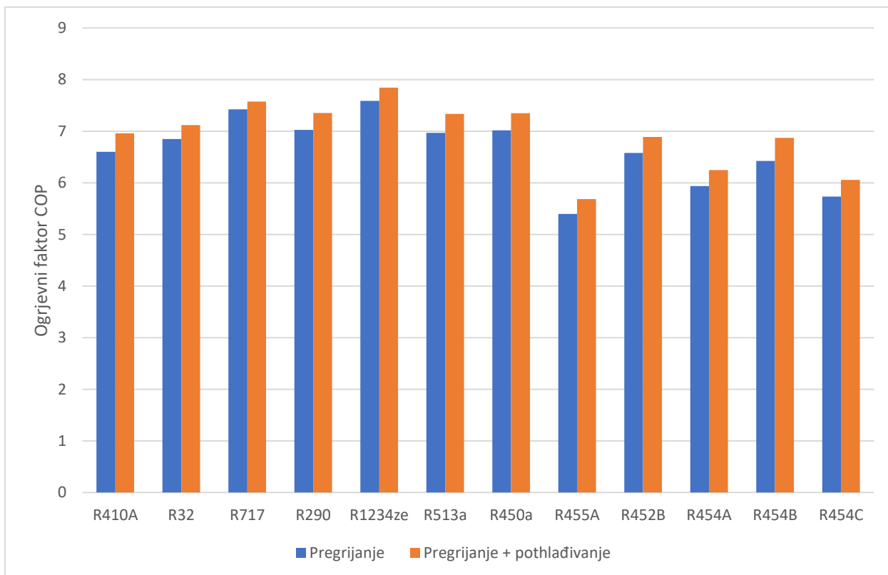
Slika 4. 11 - Faktori grijanja jednostupanjskih dizalica topline voda - voda – Zimski režim rada
