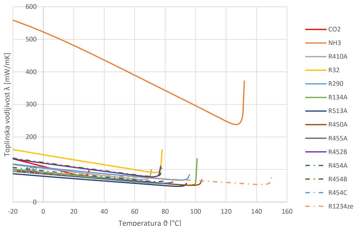
Slika 3. 10 - Ovisnost toplinske vodljivosti kapljevite faze i temperature
