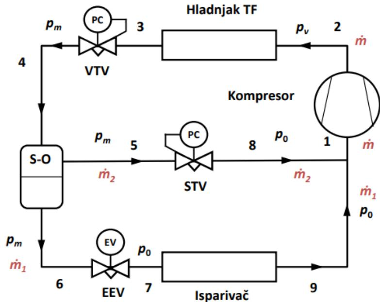
Slika 4. 20 - Shema transkriticnog jednostupanjskog procesa [32]
