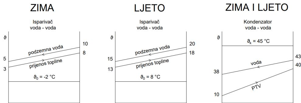
Slika 4. 3 - Promjena temperaturama u isparivaču i kondenzatoru dizalice topline voda - voda za zimski/ljetni režim rada
