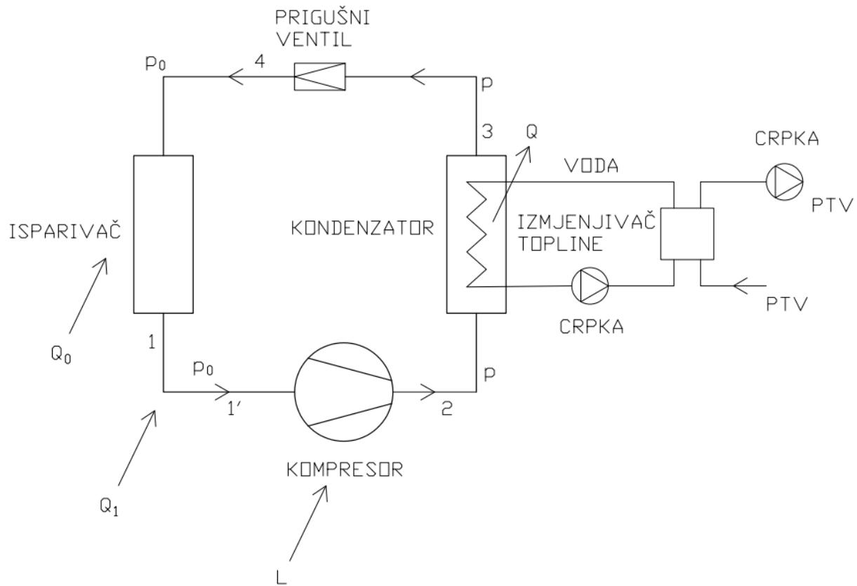
Slika 4. 4 - Shema osnovnog podkritičnog procesa s pregrijanjem
