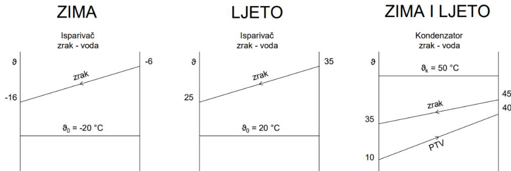
Slika 4. 2 - Promjena temperaturama u isparivaču i kondenzatoru dizalice topline zrak - voda za zimski/ljetni režim rada
