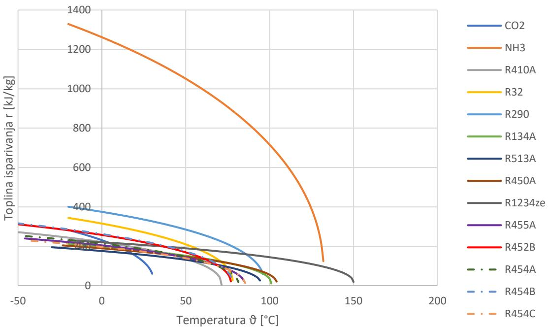
Slika 3. 12 - Ovisnost temperature i topline isparivanja
