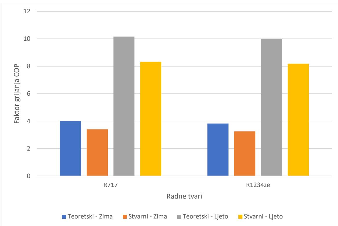
*Slika 4. 26 - Usporedba teoretskog i stvarnog faktora grijanja dizalice topline zrak - voda za zimski/ljetni režim rada - Dvostupanjski s pregrijavanjem i pothlađenjem*
