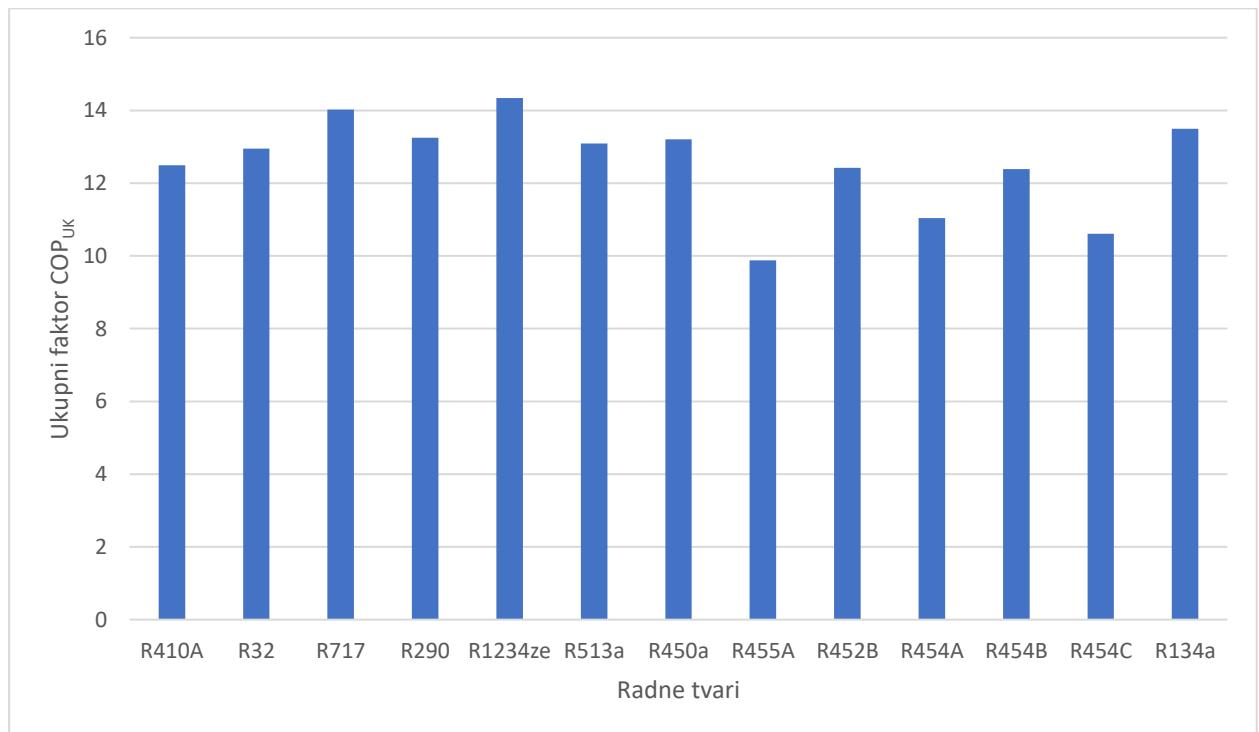
Slika 4. 30 - Ukupni faktori rashladnog uređaja za potpunu rekuperaciju -  $\vartheta_k = 40^\circ\text{C}$
