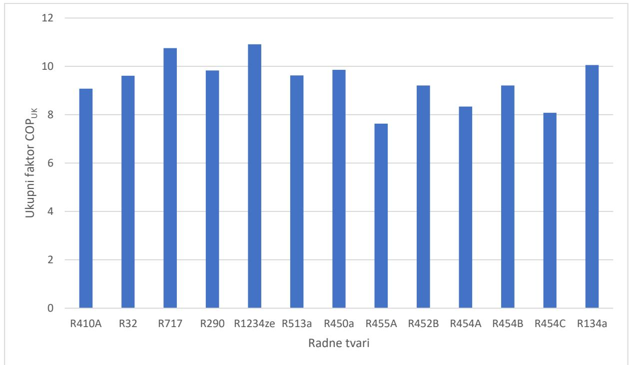
Slika 4. 29 - Ukupni faktori rashladnog uređaja za potpunu rekuperaciju -  $\vartheta_k = 50^\circ\text{C}$
