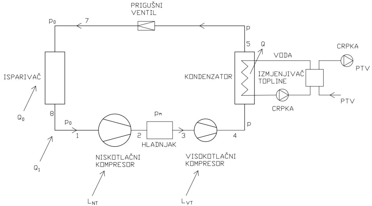
Slika 4. 13 - Shema dvostupanjskog podkritičnog procesa s pregrijanjem
