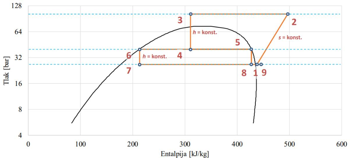
Slika 4. 21 - log p,h - dijagram transkriticnog jednostupanjskog procesa [33]
