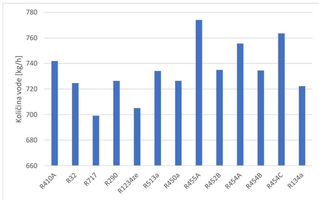
Slika 4. 32 - Količina PTV - a koju je moguće zagrijati na  $40^\circ\text{C}$  za potpunu rekuperaciju pri  $\vartheta_k = 50^\circ\text{C}$
