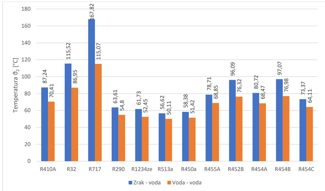
*Slika 4. 6 - Temperatura radne tvari na kraju kompresije - osnovni podkritični proces s pregrijanjem - zimski režim rada (teoretski proces)*
