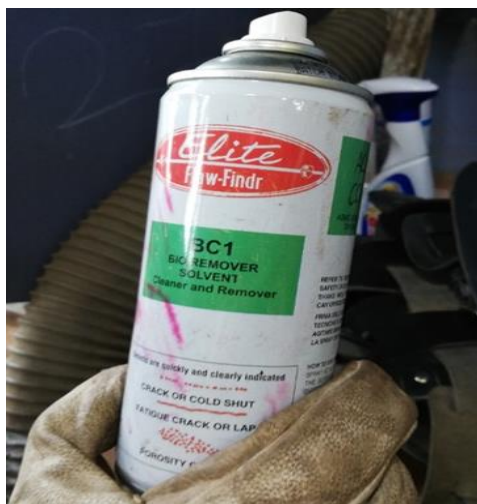
Slika 4.11 Čistač ( odmašćivač ) za pripremu površine prije ispitivanja (odmašćuje površinu). Priložen dokument kojim se potvrđuje korištenje izvornih slika brodogradilišta 3. Maj
