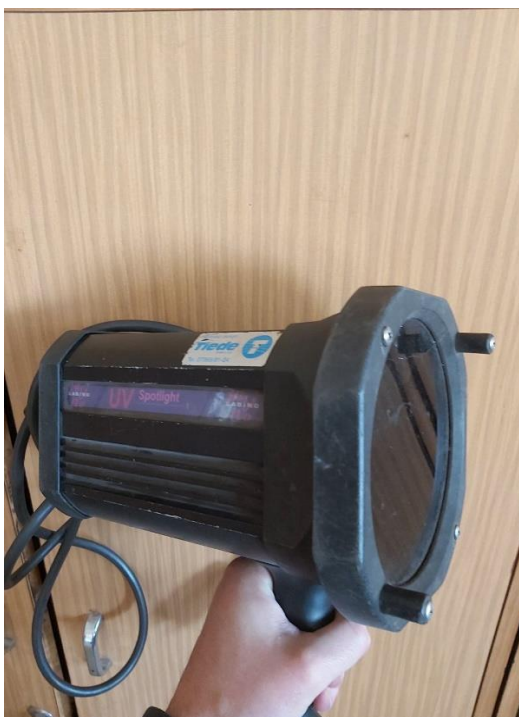
Slika 4.13 Prikaz flourescentnog alata (lampe)
