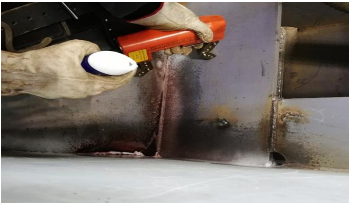
Slika 4.10 Ispitivanje magnetima i alat koji se koristi prilikom ispitivanja. Ujedno ovdje je prikaz ispitivanja kuta magnetom (jaramom) i udjedno i prikaz rukovanja istim. Zavareni spoj koji ispitujemo isti kao i kod ultrazvučne metode. Priložen dokument kojim se potvrđuje korištenje izvornih slika brodogradilišta 3. Maj
