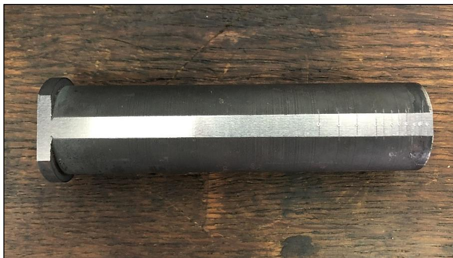
*Slika 5.17. Ispitana Jominyjeva epruveta*
