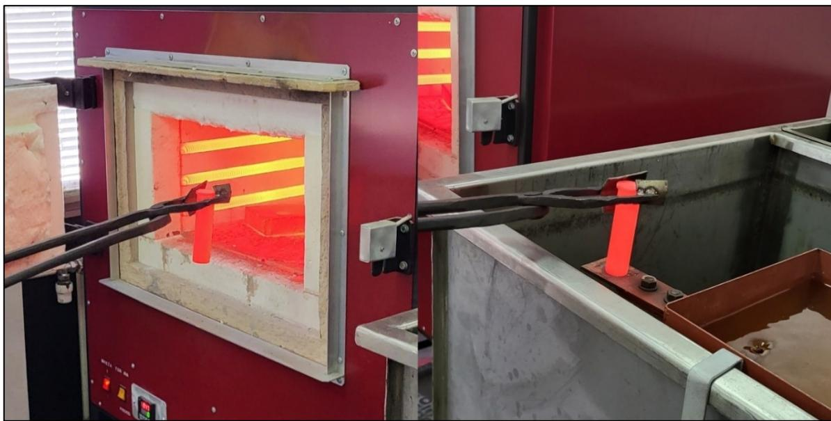
Slika 5.7. Vadenje ispitne epruvete iz komorne peći
