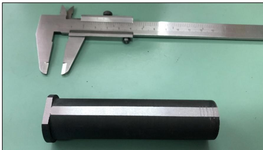
Slika 5.14. Postupak označavanja točaka ispitivanja po Jominyu
