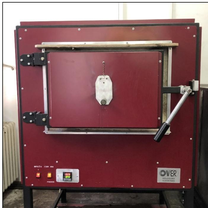
Slika 5.4. Komorna peć za žarenje, kaljenje i pougljičavanje
