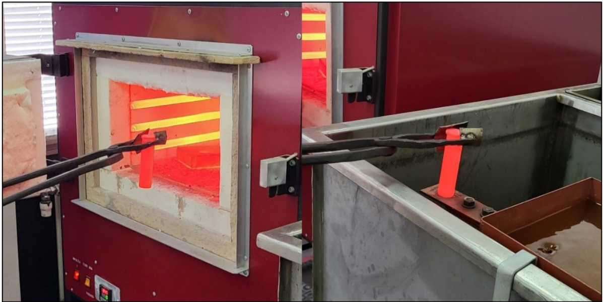
Slika 5.7. Vađenje ispitne epruvete iz komorne peći
