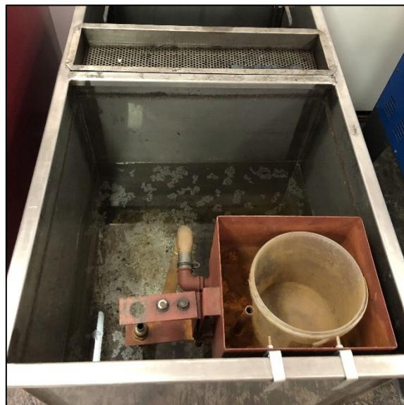
Slika 5.6. Naprava za gašenje Jominyjevog uzorka
