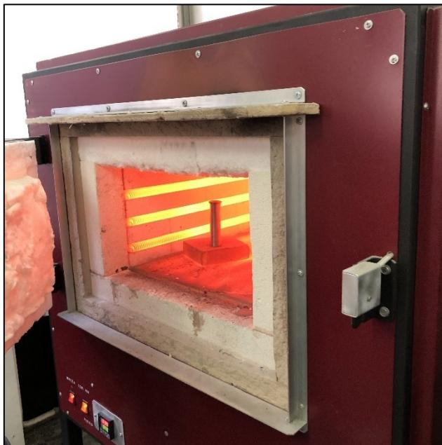
Slika 5.5. Ispitna epruveta u komornoj peći
