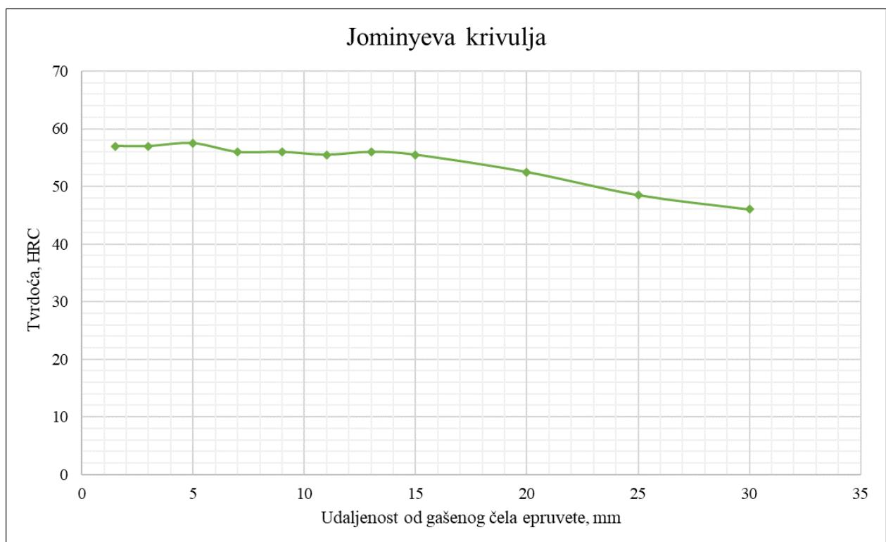
Slika 5.18. Jominyjeva krivulja za ispitni uzorak materijala 51CrV4
