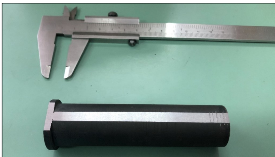
Slika 5.14. Postupak označavanja točaka ispitivanja po Jominyu
