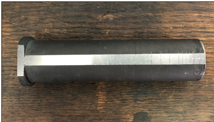
Slika 5.17. Ispitana Jominyjeva epruveta
