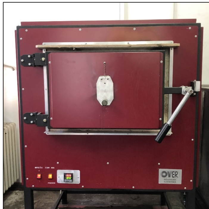
Slika 5.4. Komorna peć za žarenje, kaljenje i pougljičavanje
