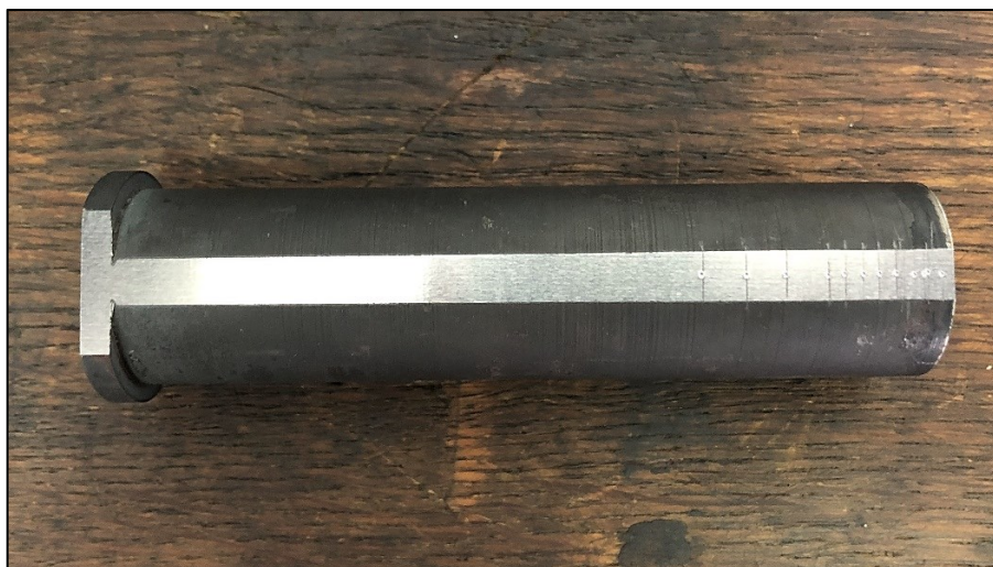
Slika 5.17. Ispitana Jominyjeva epruveta
