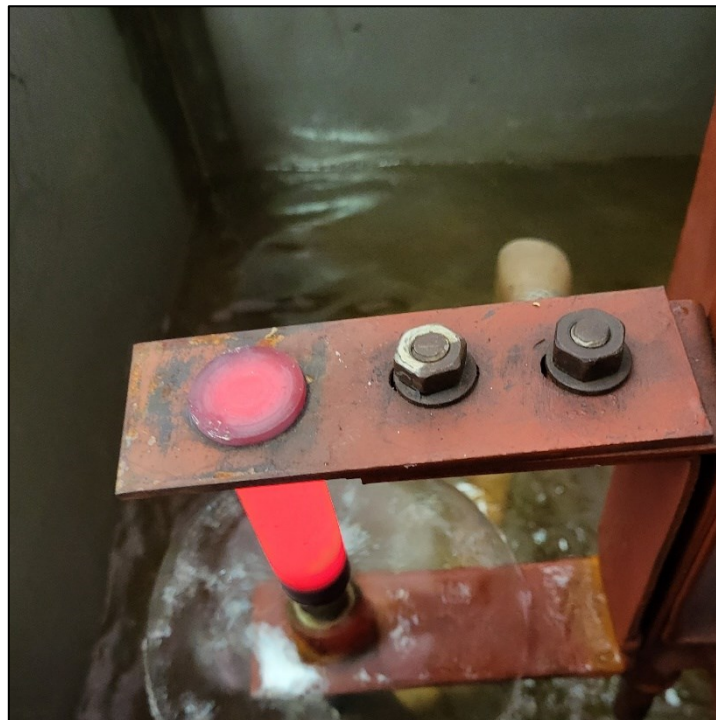
Slika 5.8. Početak gašenja ispitnog uzorka
