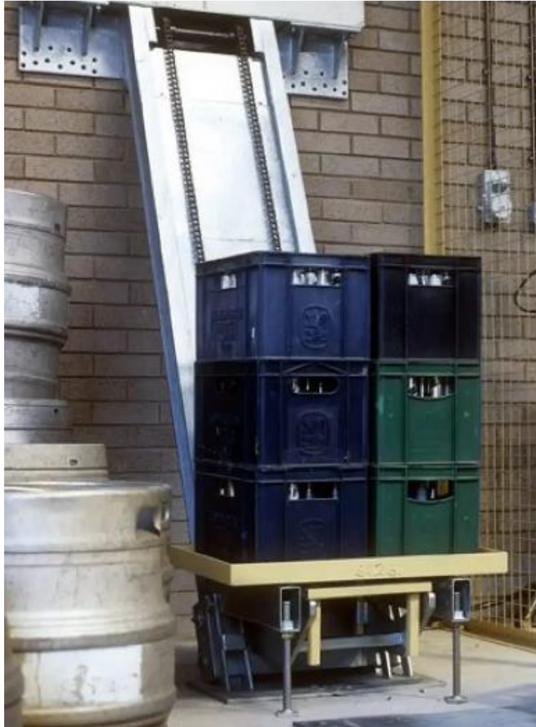
Slika 3.4 Elevator za transport kutija [5]
