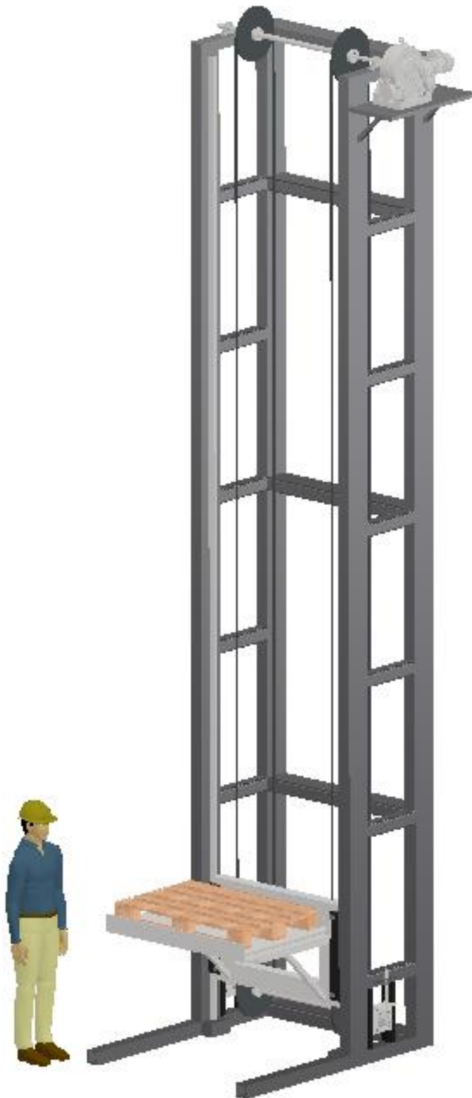
Slika 10.1 Kompletan prikaz elevatora
