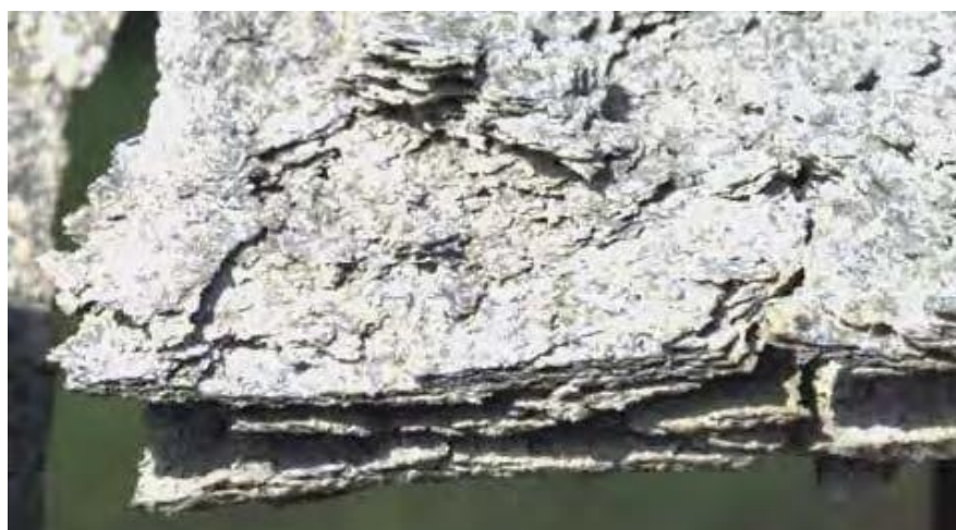
Slika 5.11. Eksfolijacija aluminijske legure [4]
