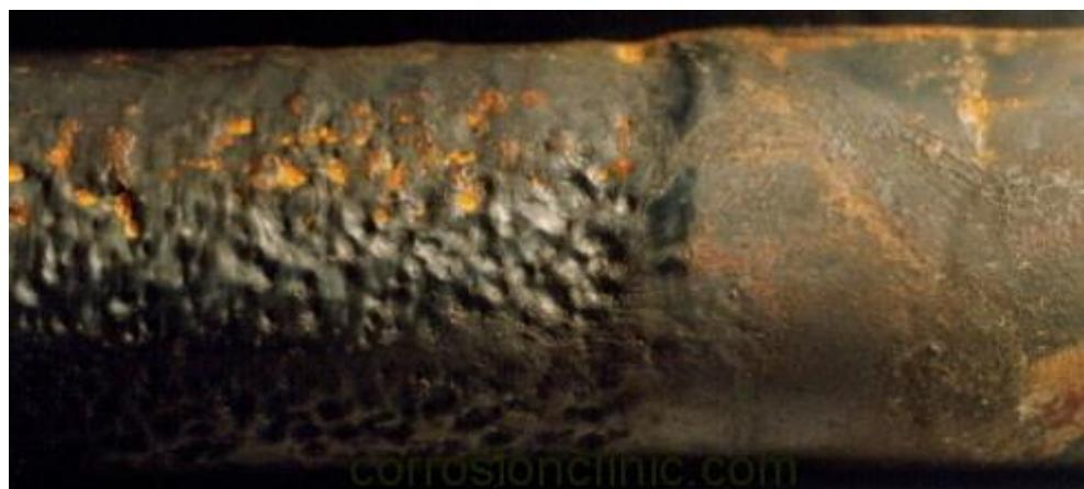
Slika 5.20. Udarna korozija [42]
