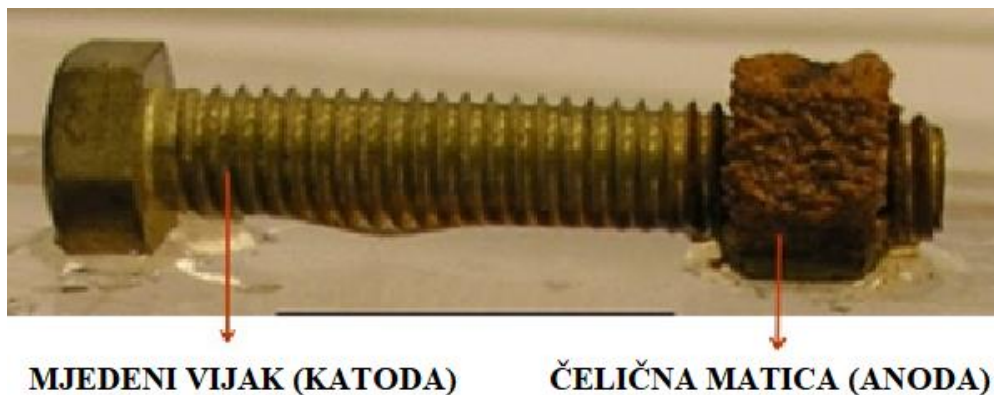
Slika 5.28. Galvanska korozija čelične matice na mjedenom vijku [12]
