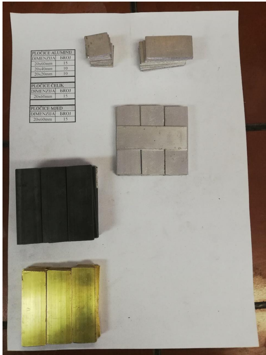
Slika 6.8. Izrezani ispitni uzorci
