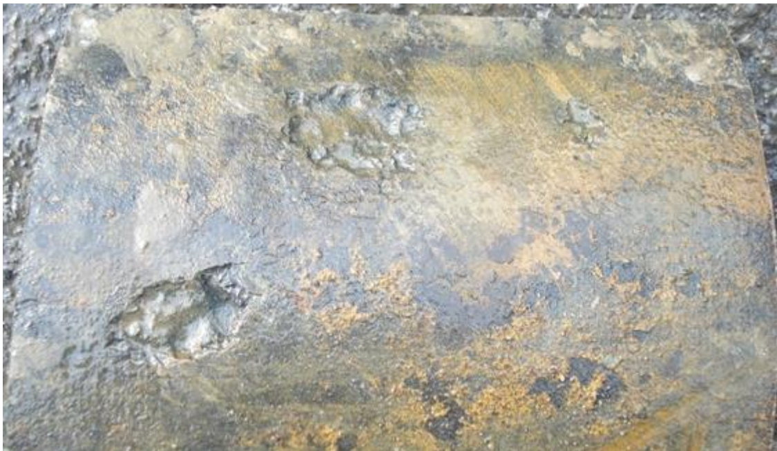
Slika 5.8. Grafitizacija sivog lijeva [30]
