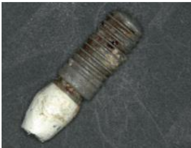
Slika 5.18. Korozija titanijevog zubnog implantata [39]
