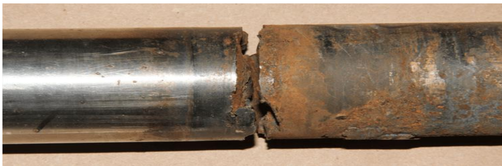
Slika 5.15. Lom vratila kao posljedica korozijskog zamora [36]
