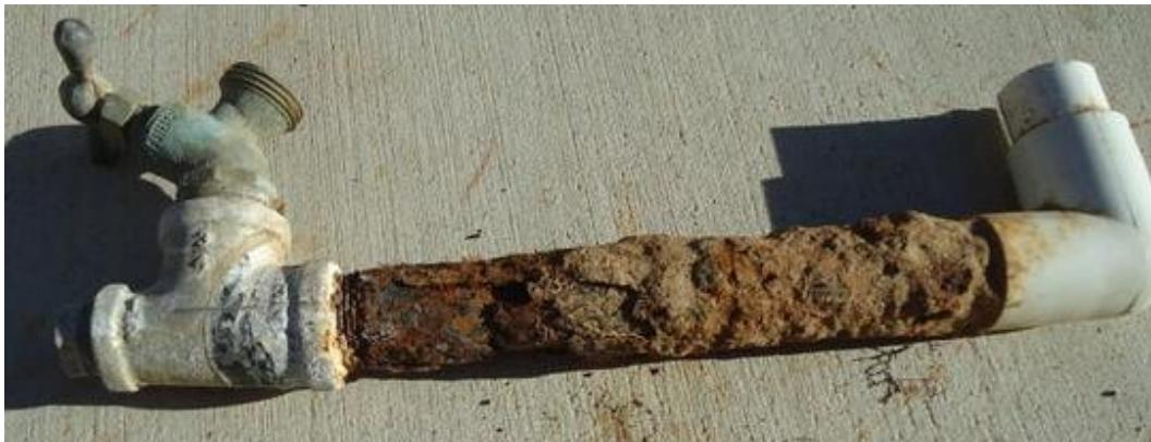
Slika 5.29. Galvanska korozija pocićane čelične cijevi [52]
