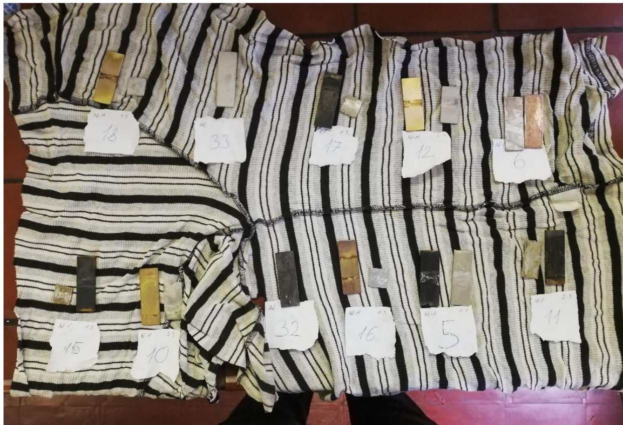
Slika 6.31. Sušenje ispitnih uzoraka
