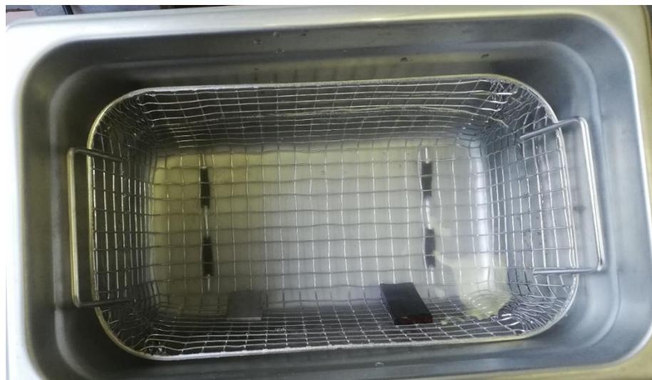
Slika 6.30. Ultrazvučno čišćenje uzorka
