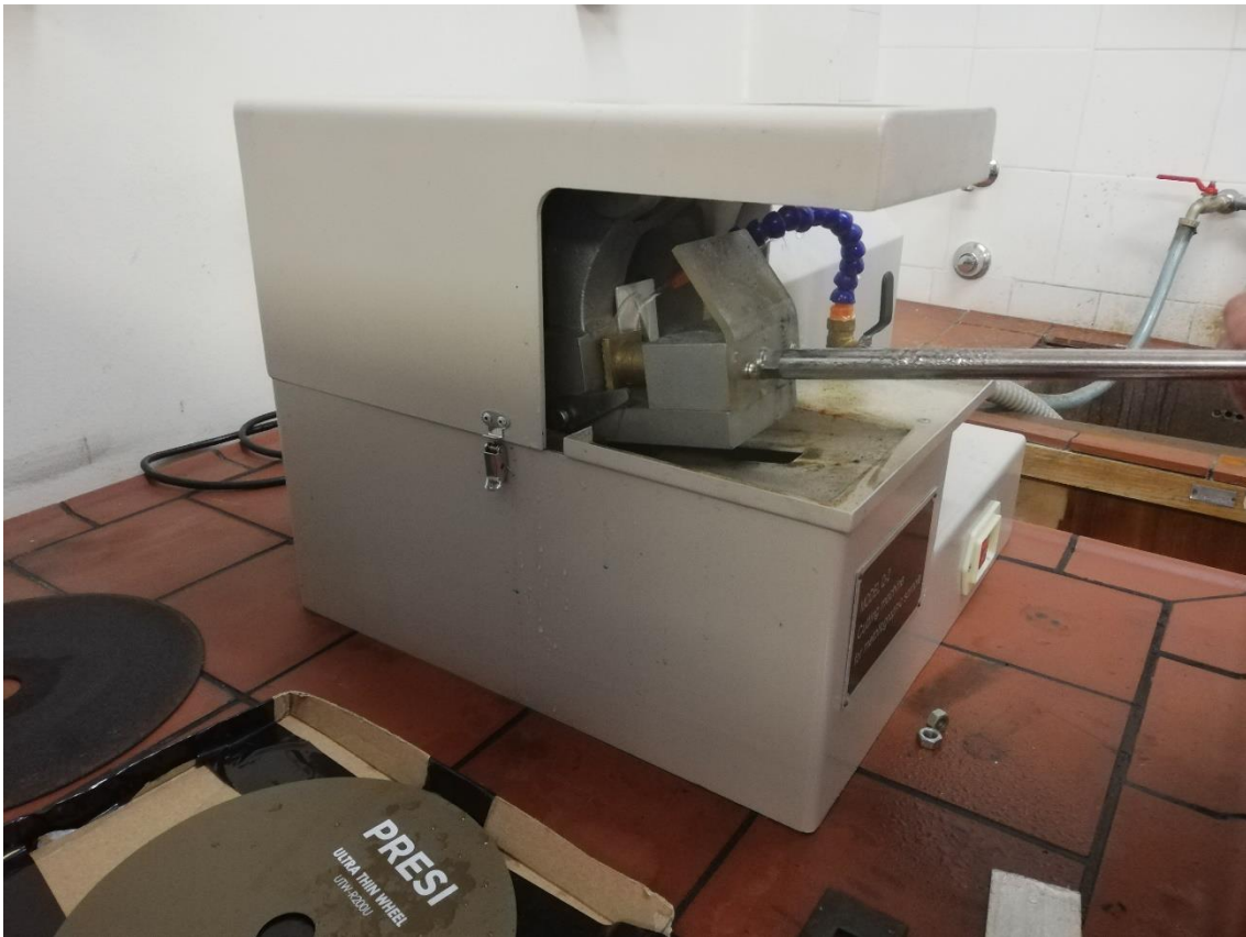
Slika 6.7. Izrezivanje ispitnih uzoraka od aluminija
