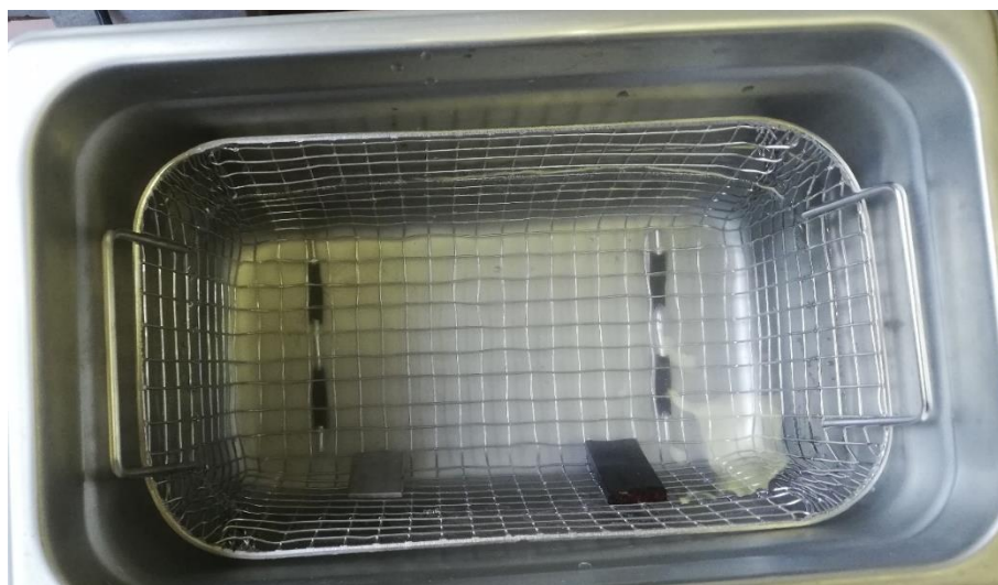
Slika 6.30. Ultrazvučno čišćenje uzoraka
