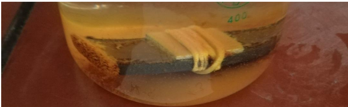
Slika 6.23. Kombinacija aluminijska i čelika u slatkoj vodi u omjeru 1:3 (uzorak 15) – drugi pregled
