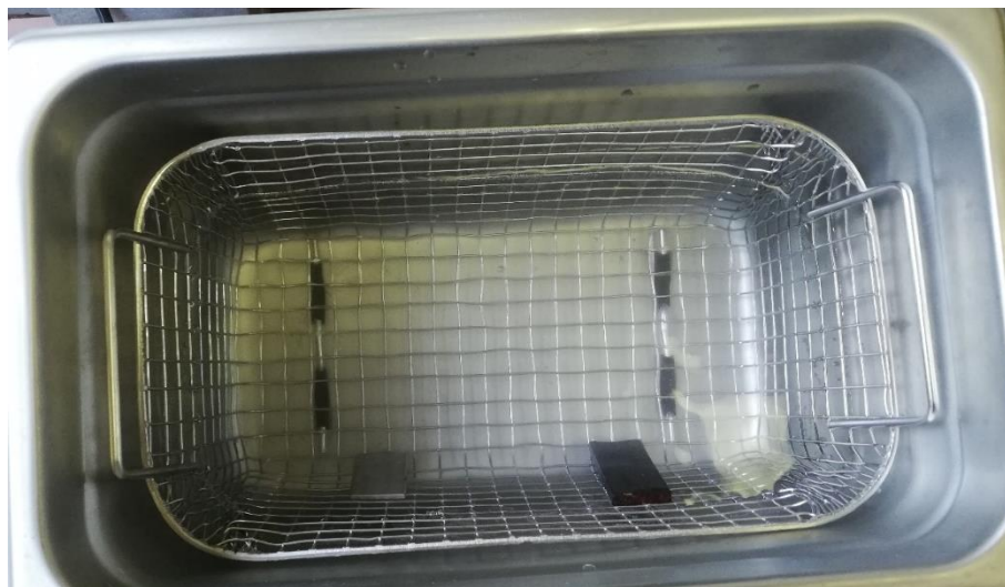
Slika 6.30. Ultrazvučno čišćenje uzoraka
