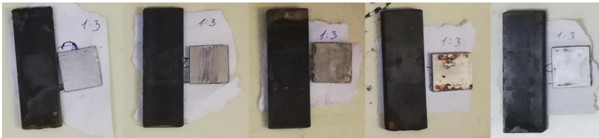
Slika 6.41. Izgled ispitnih uzoraka u ovisnosti o vrsti medija: 13 (zemlja), 15 (slatka voda), 17 (morska voda), 27 (zemlja (R)) i 29 (slatka voda (R)). Omjer površina aluminija i čelika 1:3
