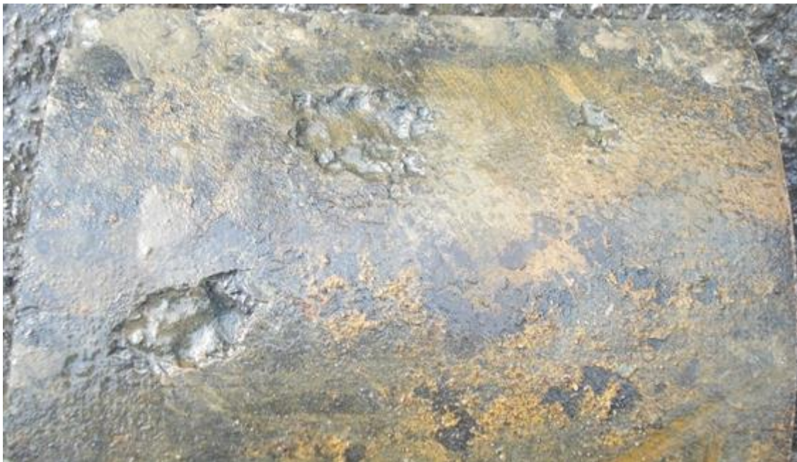
Slika 5.8. Grafitizacija sivog lijeva [30]
