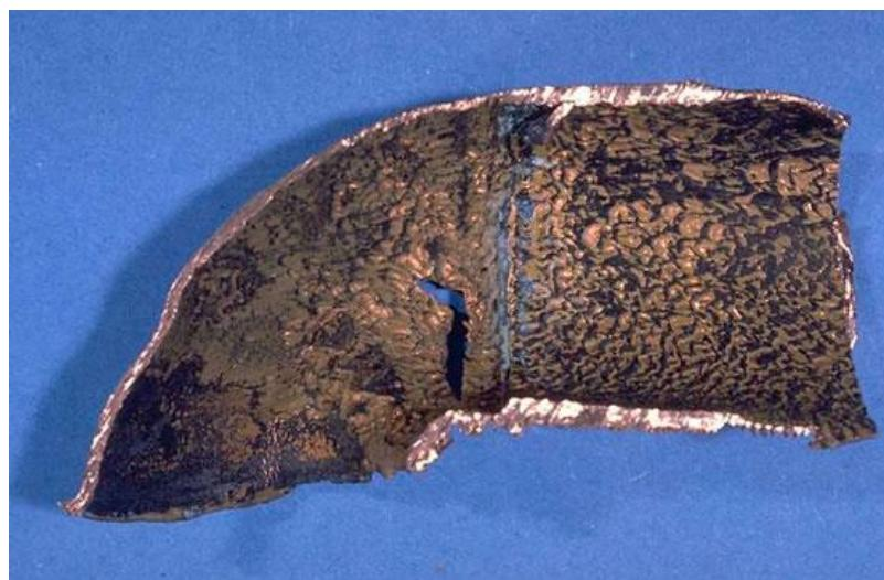
Slika 5.19. Erozijska korozija bakrene cijevi [40]
