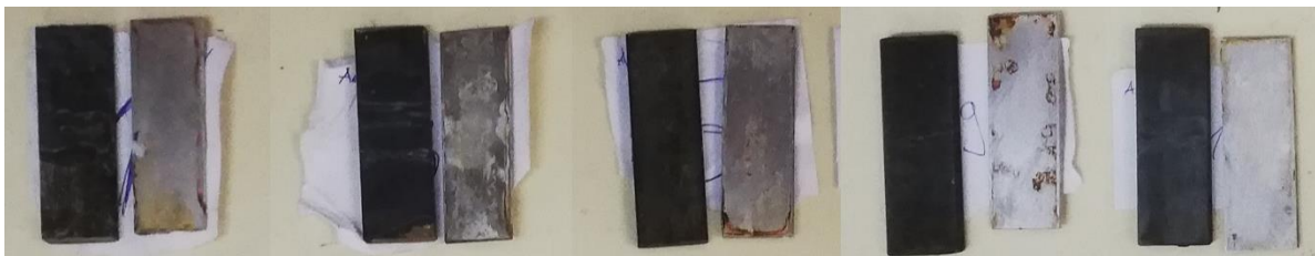
Slika 6.33. Izgled ispitnih uzoraka u ovisnosti o vrsti medija: 1 (zemlja), 3 (slatka voda), 5 (morska voda), 19 (zemlja (R)) i 21 (slatka voda (R)). Omjer površina aluminija i čelika 1:1
