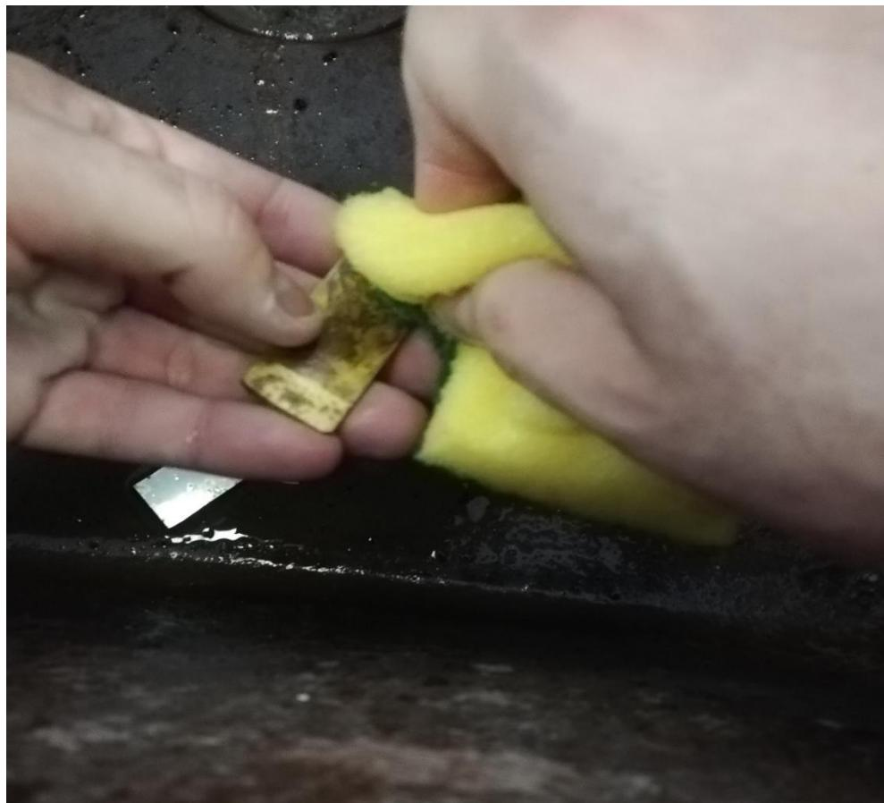
Slika 6.28. Čišćenje ispitnih uzoraka (uzorak 12)
