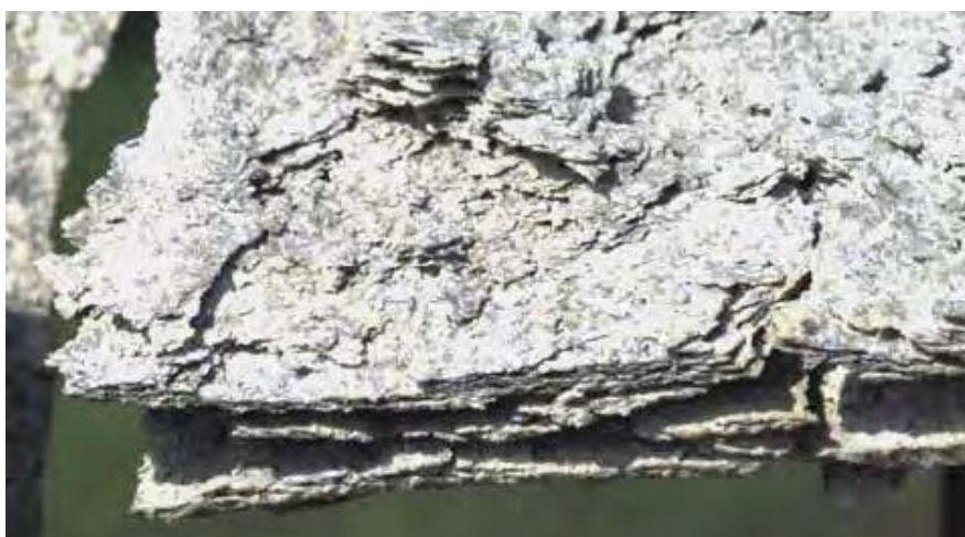
Slika 5.11. Eksfolijacija aluminijske legure [4]
