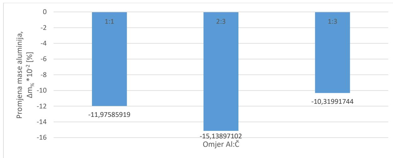
Slika 6.54. Promjena mase aluminija ovisno o omjeru Al:Č u uzorcima: 5 (omjer 1:1), 11 (omjer 2:3) i 17 (omjer 1:3) u laboratorijskim uvjetima. Uzorci su postavljeni u morskoj vodi.
