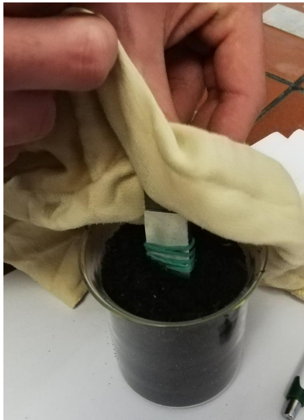
Slika 6.11. Postavljanje ispitnog uzorka u zemlju
