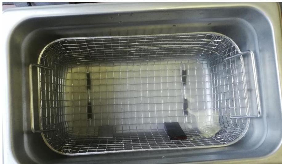
Slika 6.30. Ultrazvučno čišćenje uzorka
