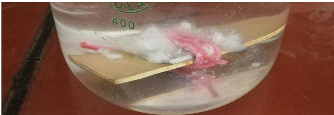
Slika 6.24. Kombinacija aluminija i mjedi u slatkoj vodi u omjeru 1:3 (uzorak 16) – drugi pregled
