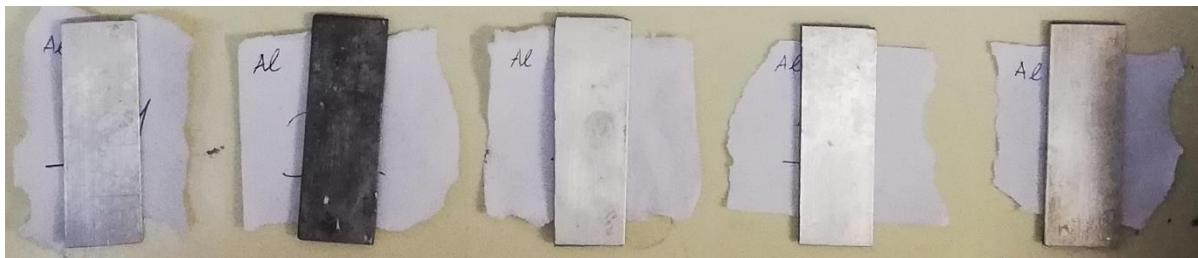
*Slika 6.45. Izgled ispitnih uzoraka u ovisnosti o vrsti medija: 31 (zemlja), 32 (slatka voda), 33 (morska voda), 34 (zemlja (R)) i 35 (slatka voda (R)). Aluminij bez kontakta sa drugim metalom.*
