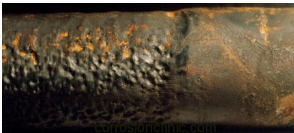
Slika 5.20. Udarna korozija [42]
