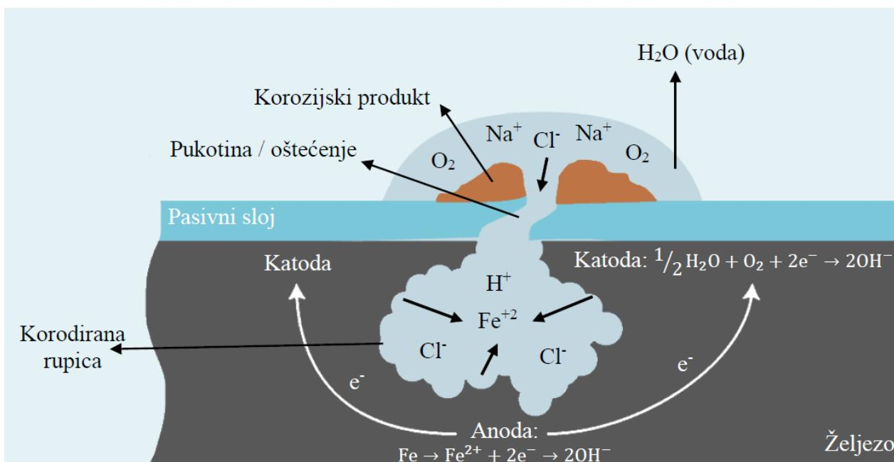
*Slika 5.4. Proces nastajanja rupičaste korozije [12]*
