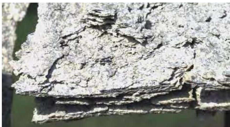
Slika 5.11. Eksfolijacija aluminijske legure [4]
