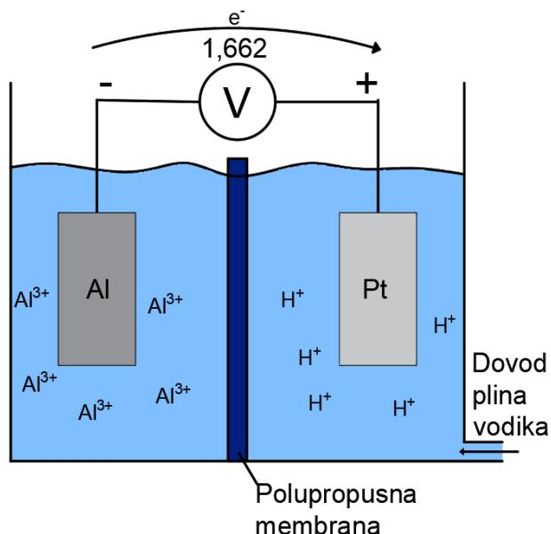
Slika 4.3. Galvanski članak sa elektrodama aluminija i platine
