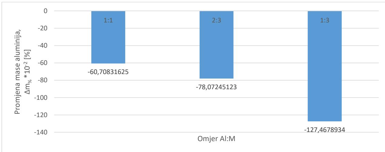
*Slika 6.56. Promjena mase aluminija ovisno o omjeru Al:M u uzorcima: 6 (omjer 1:1), 12 (omjer 2:3) i 18 (omjer 1:3) u laboratorijskim uvjetima. Uzorci su postavljeni u morskoj vodi.*
