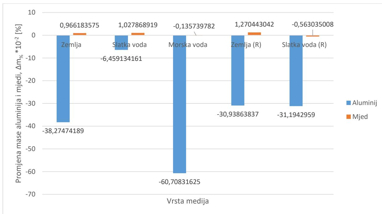
*Slika 6.34. Promjena mase uzorka u ovisnosti o vrsti medija: 2 (zemlja), 4 (slatka voda), 6 (morska voda), 20 (zemlja (R)) i 22 (slatka voda (R)). Omjer površina aluminija i mjedi 1:1*
