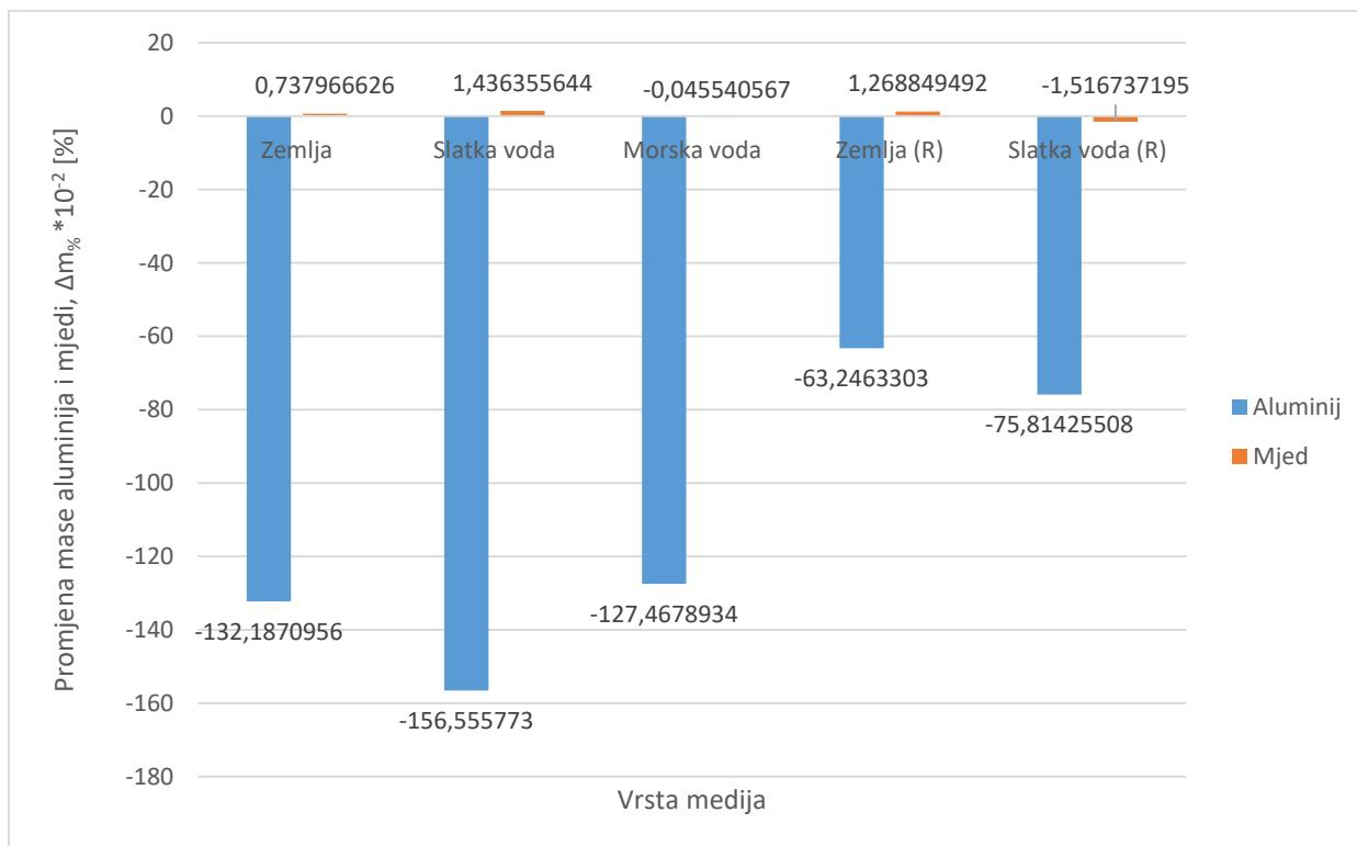
Slika 6.42. Promjena mase uzorka u ovisnosti o vrsti medija: 14 (zemlja), 16 (slatka voda), 18 (morska voda), 28 (zemlja (R)) i 30 (slatka voda (R)). Omjer površina aluminija i mjeni 1:3
