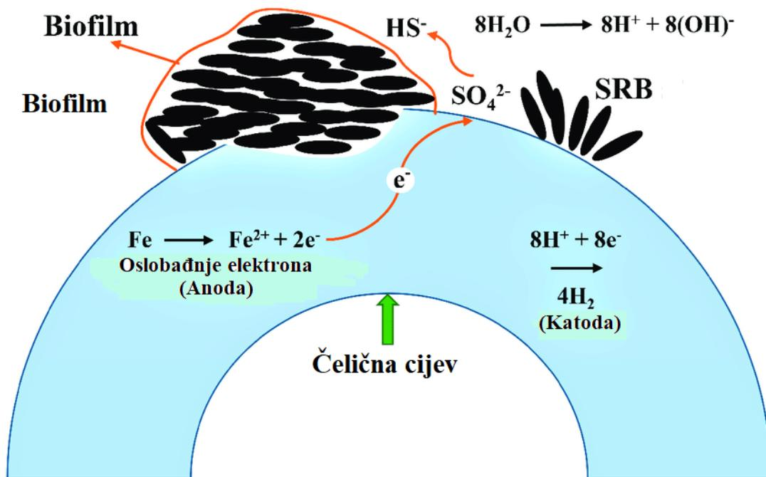
Slika 5.16. Korozija čelika djelovanjem metaboličke aktivnosti SRB bakterije
