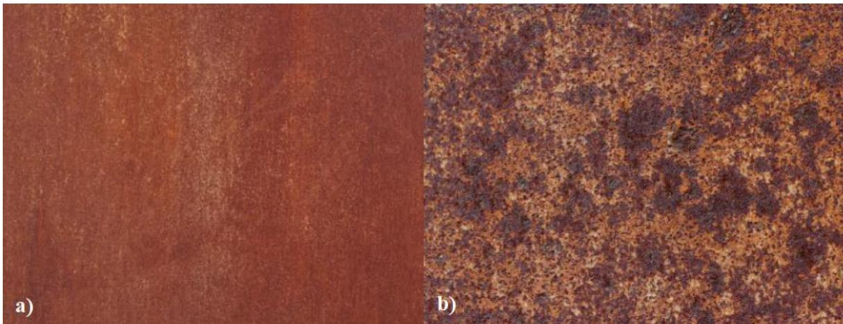
*Slika 5.2. a) Ravnomjerna korozija b) Neravnomjerna korozija [12]*
