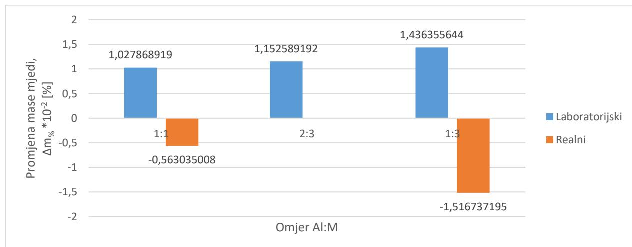
Slika 6.53. Promjena mase mjedi ovisno o omjeru Al:M u uzorcima: 4 (omjer 1:1), 10 (omjer 2:3) i 16 (omjer 1:3) u laboratorijskim uvjetima te uzorcima: 22 (omjer 1:1), 26 (omjer 2:3) i 30 (omjer 1:3) u realnim uvjetima. Uzorci su postavljeni u slatkoj vodi.
