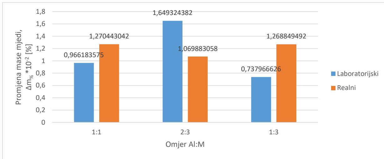
Slika 6.49. Promjena mase mјedi ovisno o omjeru Al:M u uzorcima: 2 (omjer 1:1), 8 (omjer 2:3) i 14 (omjer 1:3) u laboratorijskim uvjetima te uzorcima: 20 (omjer 1:1), 24 (omjer 2:3) i 28 (omjer 1:3) u realnim uvjetima. Uzorci su postavljeni u zemlji.
