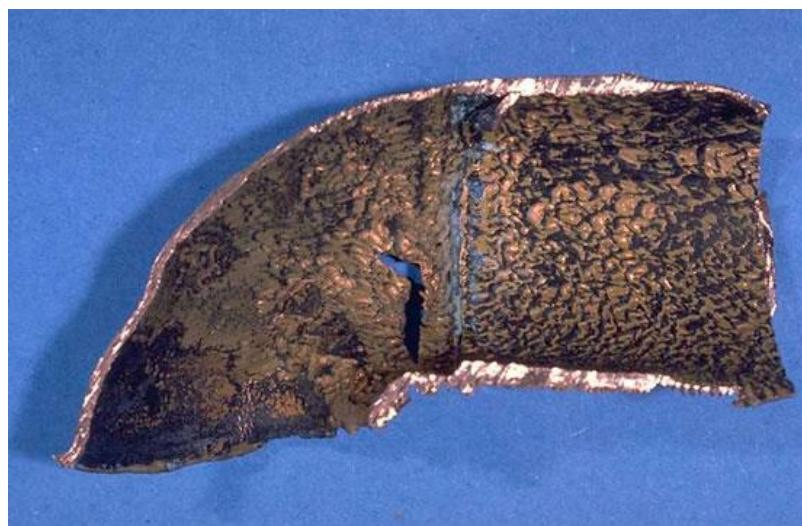
Slika 5.19. Erozijska korozija bakrene cijevi [40]
