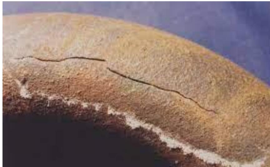
*Slika 5.14. Napetosna korozija na savijenom dijelu cijevi [35]*
