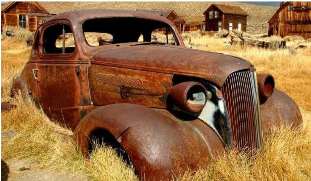
Slika 5.1. Opća korozija napuštenog automobila [22]
