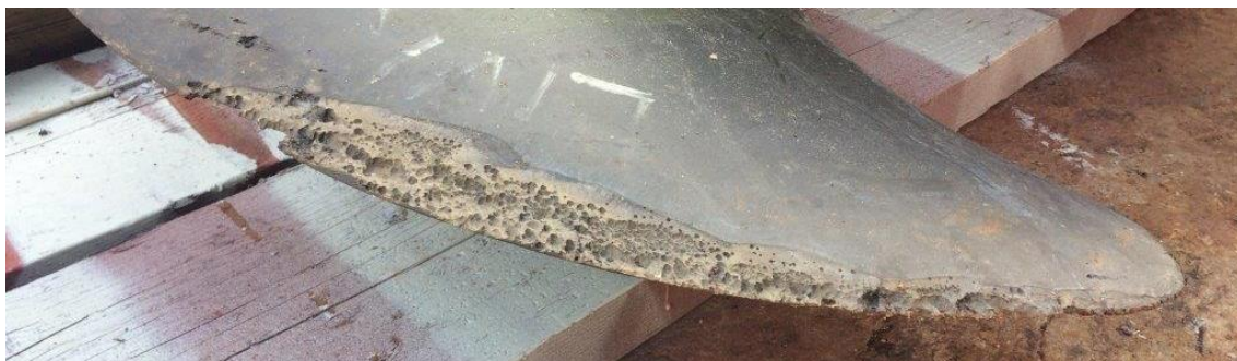
Slika 5.21. Kavitacija brodskog propelera [44]
