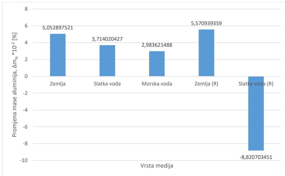
*Slika 6.44. Promjena mase uzoraka u ovisnosti o vrsti medija: 31 (zemlja), 32 (slatka voda), 33 (morska voda), 34 (zemlja (R)) i 35 (slatka voda (R)). Aluminij bez kontakta sa drugim metalom.*
