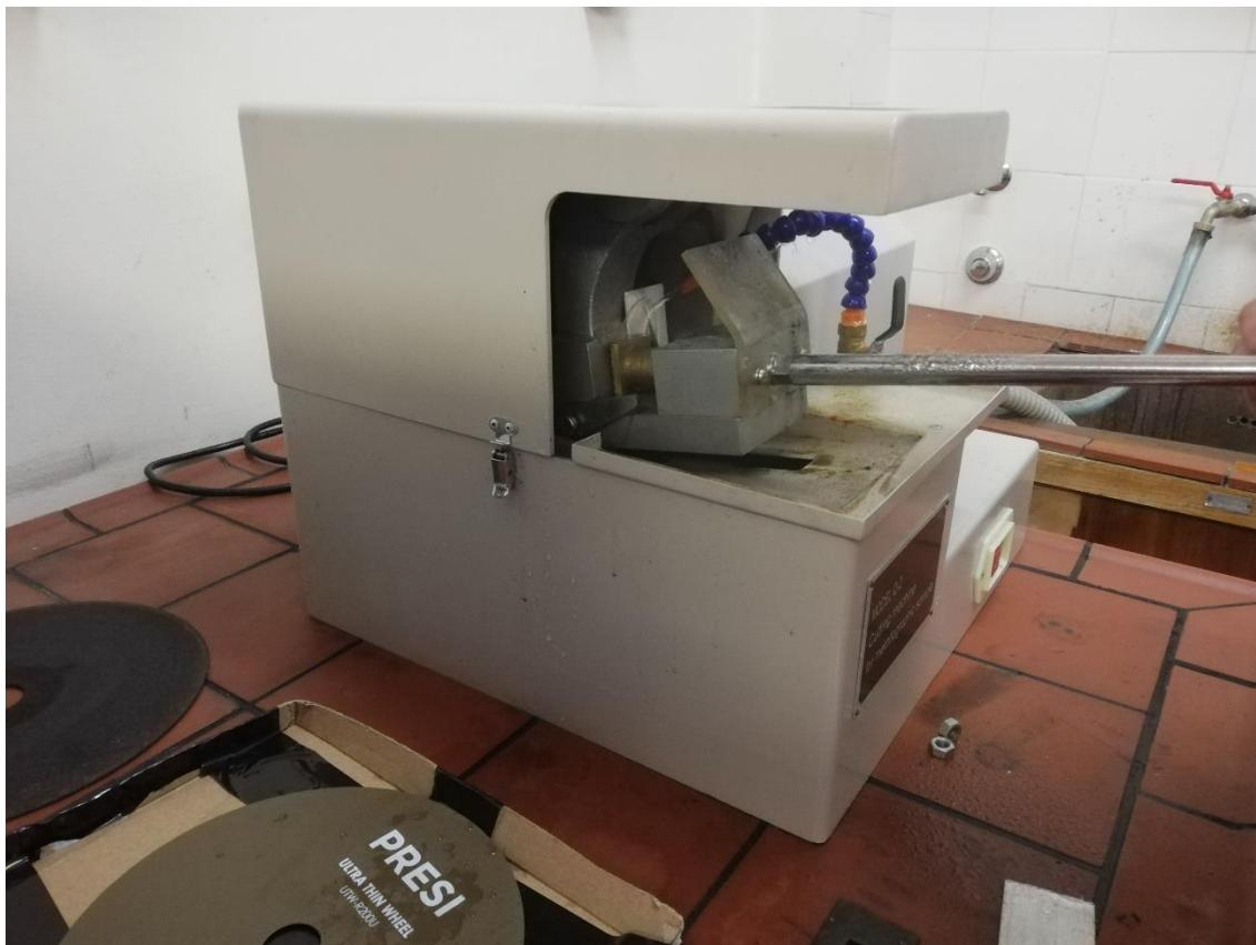
Slika 6.7. Izrezivanje ispitnih uzoraka od aluminija
