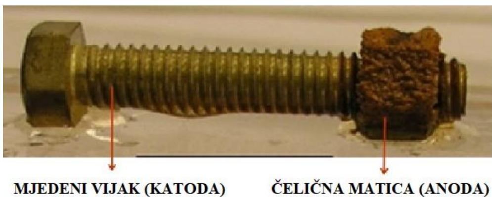
Slika 5.28. Galvanska korozija čelične matice na mjedenom vijku [12]
