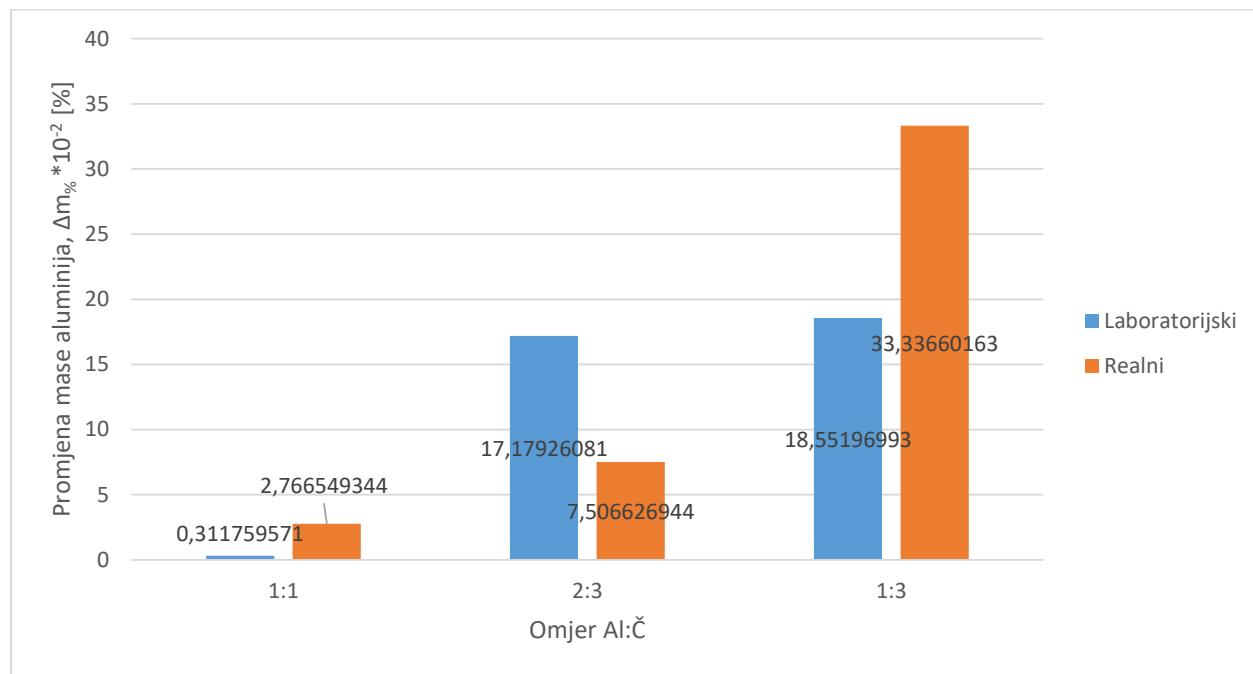
*Slika 6.46. Promjena mase aluminija ovisno o omjeru Al:Č u uzorcima: 1 (omjer 1:1), 7 (omjer 2:3) i 13 (omjer 1:3) u laboratorijskim uvjetima te uzorcima: 19 (omjer 1:1), 23 (omjer 2:3) i 27 (omjer 1:3) u realnim uvjetima. Uzorci su postavljeni u zemlji.*
