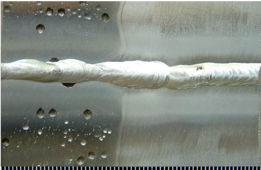
Slika 5.5. Rupičasta korozija AISI 304L nehrđajućeg čelika [4]
