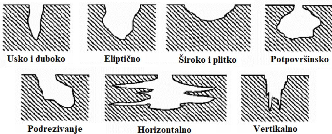
*Slika 5.3. Mehanizmi prodiranja rupičaste korozije*
