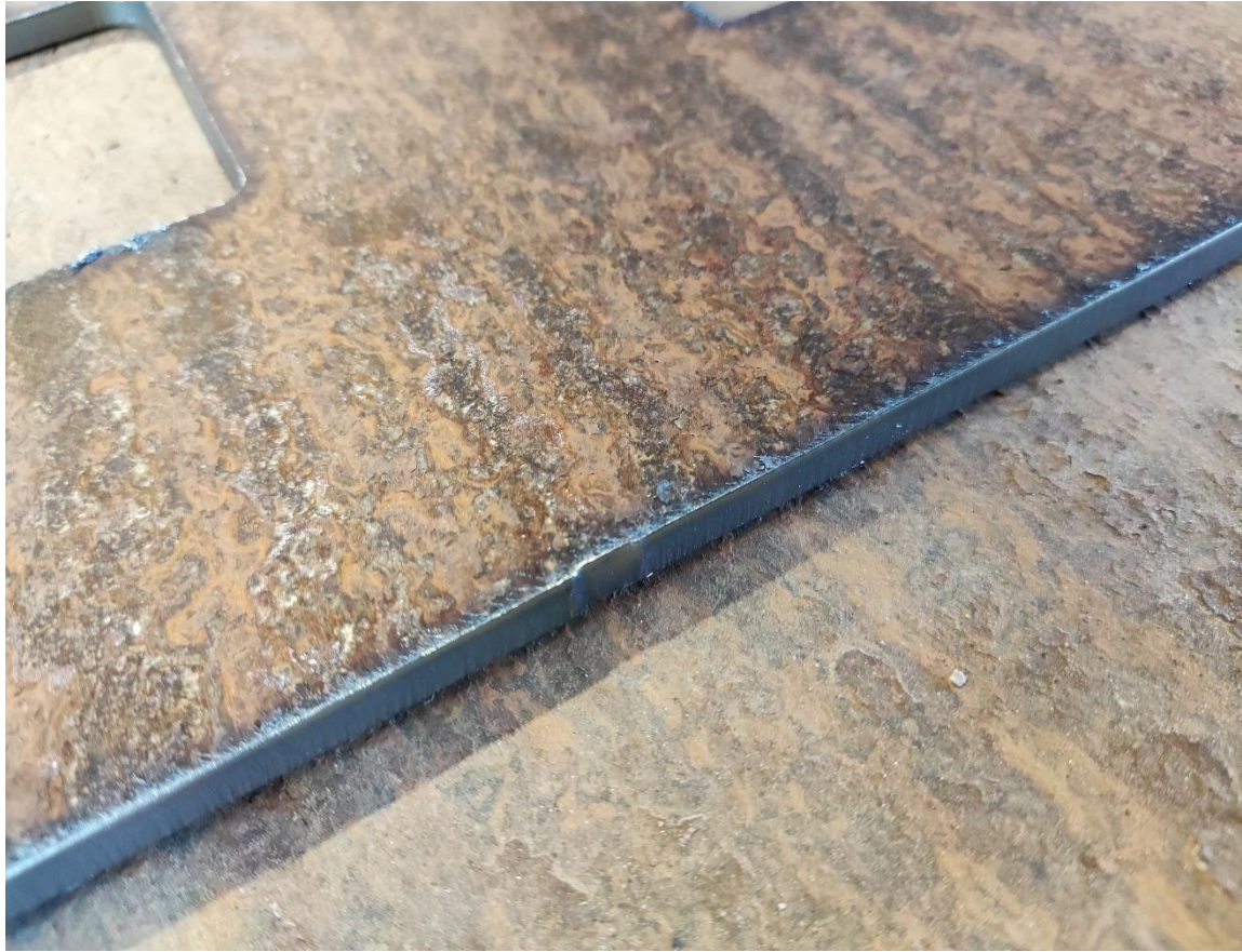
Slika 7.9. Prikaz odrezne površine (PBM)
