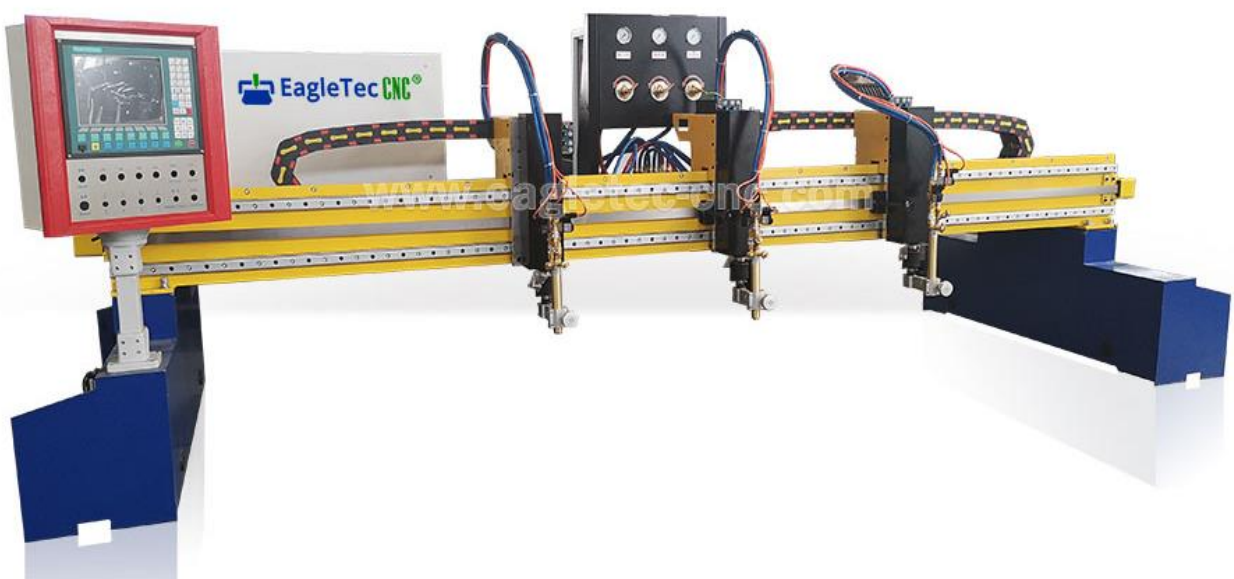
Slika 5.6. Automatiziran način rada s više mlaznica [22]
