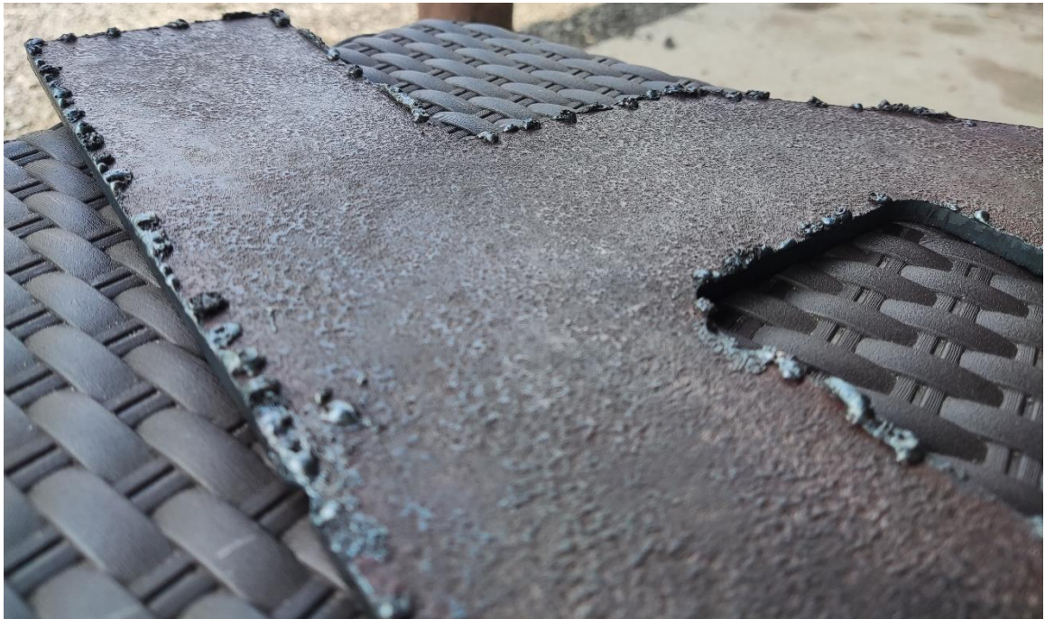
Slika 7.18. Izgled odrezne površine (plinsko rezanje)
