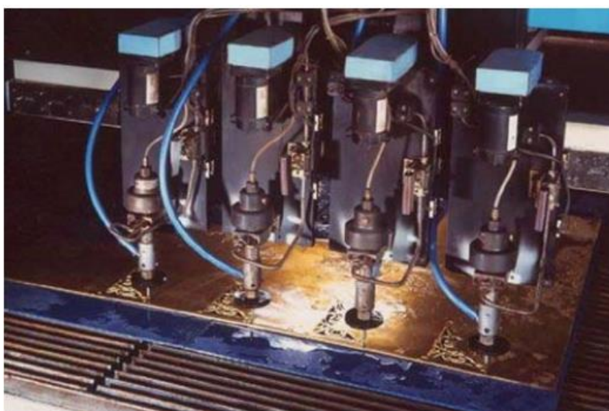
Slika 3.6. Rad s više mlaznica istovremeno [4]
