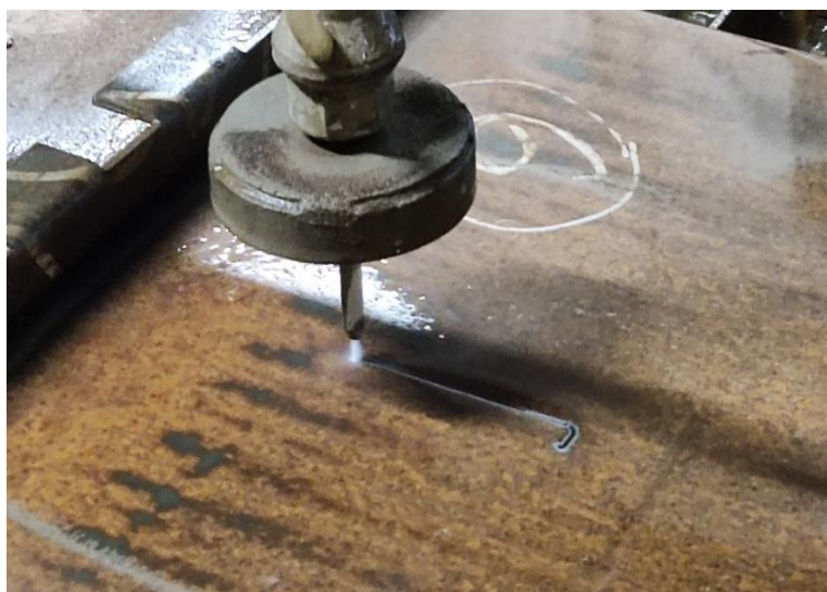
Slika 7.28. Proces rezanja (AWJM)
