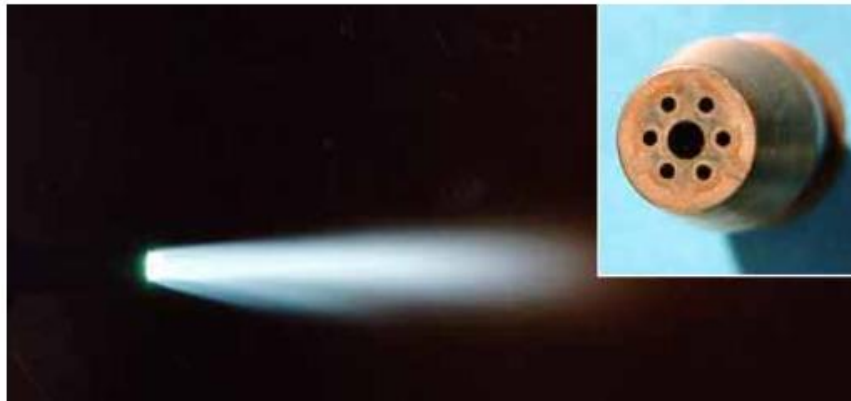
Slika 5.7. Dizajn mlaznice i acetilenski plinski mlaz [16]
