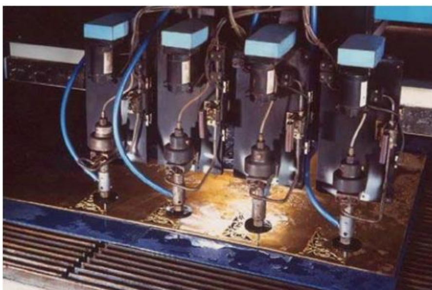
Slika 3.6. Rad s više mlaznica istovremeno [4]
