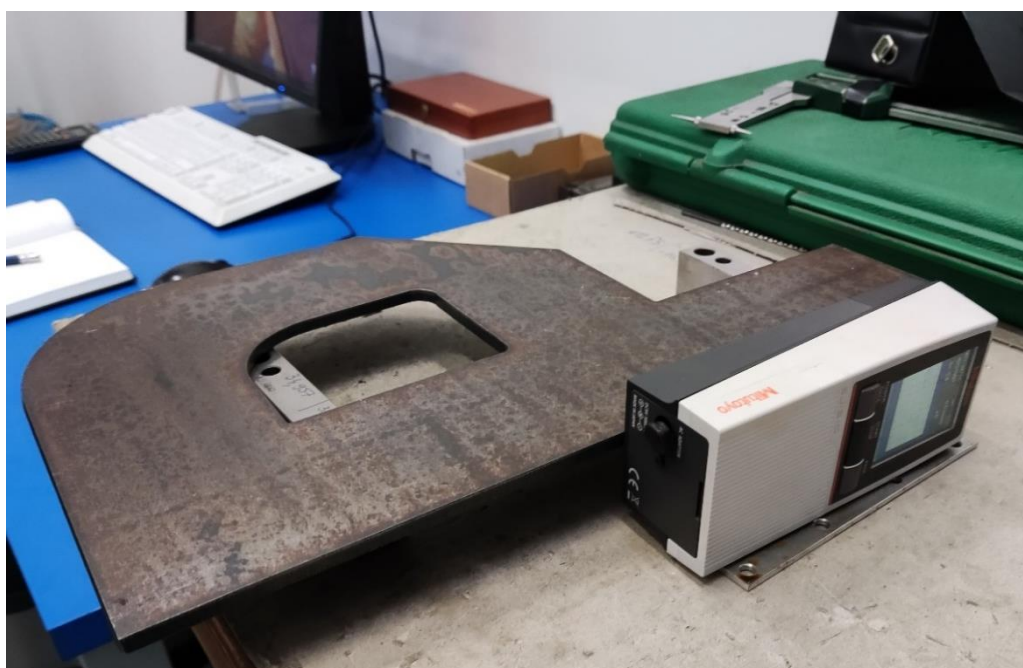
Slika 7.11. Mjerenje hrapavosti na dužini „A“ (PBM)
