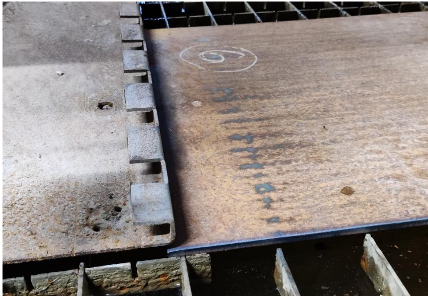
Slika 7.26. Postavljanje ploče do graničnika
