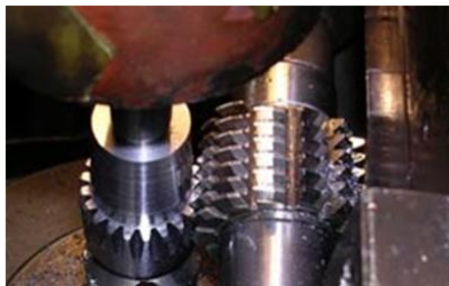
Slika 3.4. Odvalno glodanje zupčanika [3]
