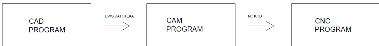
Slika 5.1. proces izrade NC koda
