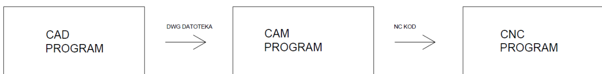
Slika 5.1. proces izrade NC koda
