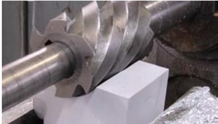
Slika 3.6. Obimno ravno glodanje [3]
