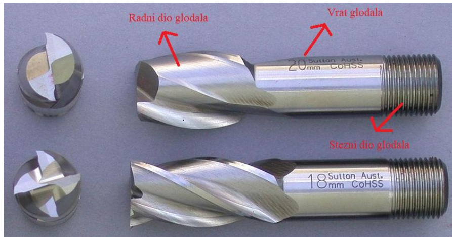
Slika 3.7. Glavni dijelovi glodala
