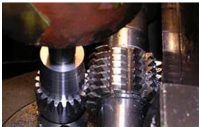
Slika 3.4. Odvalno glodanje zupčanika [3]
