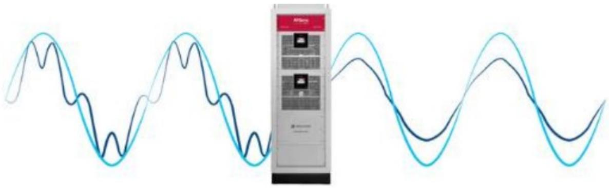
*Slika 3.8. Princip rada aktivnog filtera [14]*
