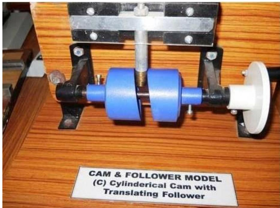
Slika 1.1. Cilindrični krivuljni mehanizam s translacijskim podizačem[3]
