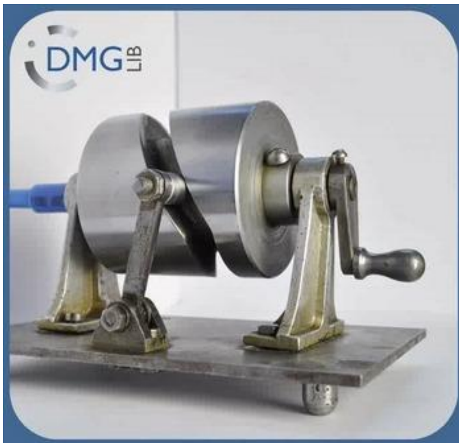
Slika 1.2. Cilindrični krivuljni mehanizam s oscilacijskim podizačem- model se koristi u Laboratoriju za mehanizme na Politehničkom sveučilištu u Temišvaru, Rumunjska[4]
