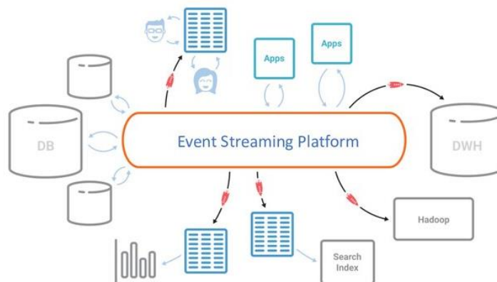
Slika 2.6. Prikaz komunikacijske arhitekture sučelja za prijenos događaja, s Interneta,
