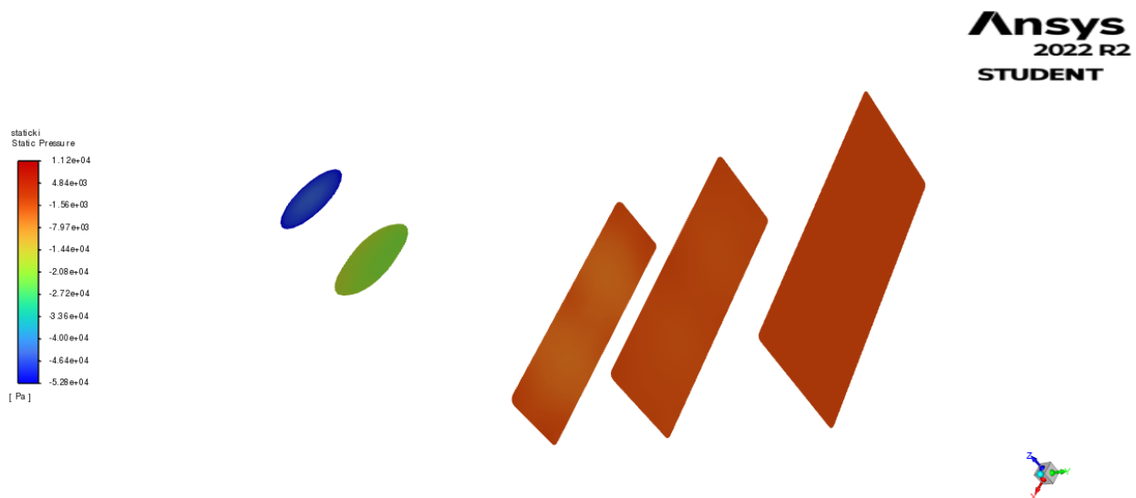
Slika 7.3. Konture statičkog tlaka po presjecima
