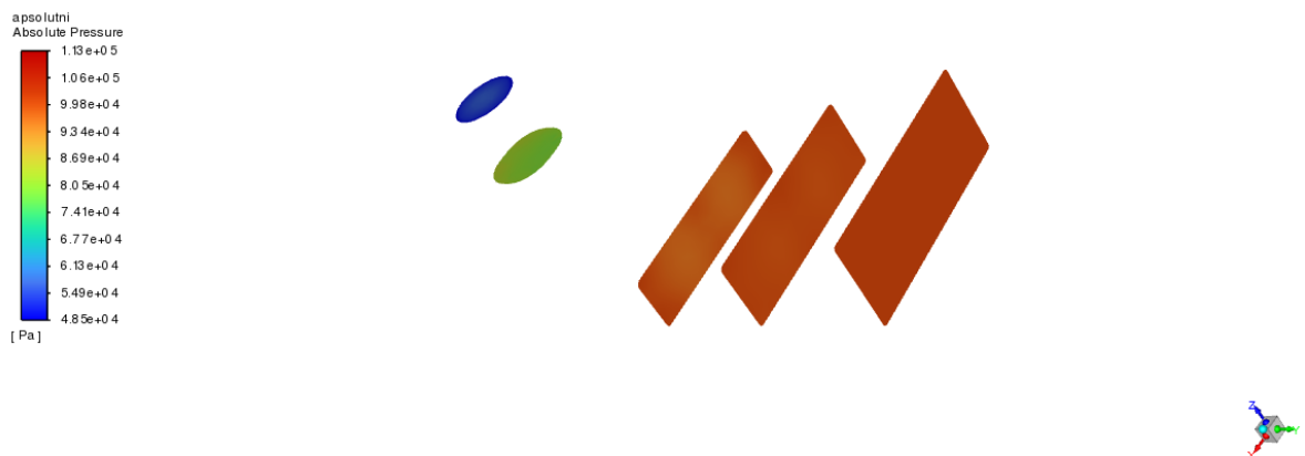
Slika 7.7. Konture apsolutnog tlaka po presjecima
