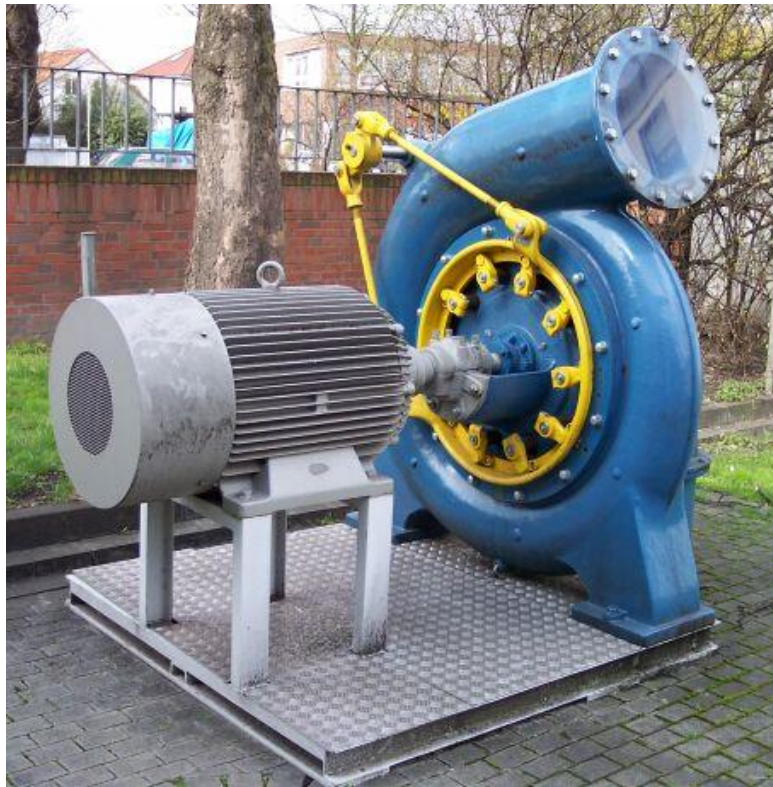
Slika 3.5. Francis-ova turbina spojena na električni generator [6]
