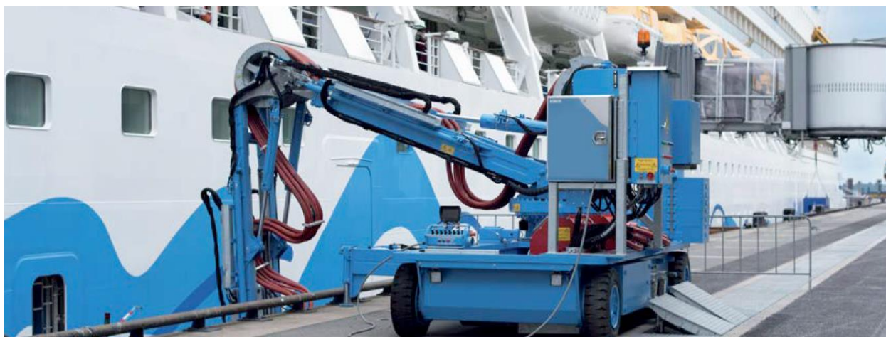
Slika 5.2 Pokretni kablenski kran [18]
