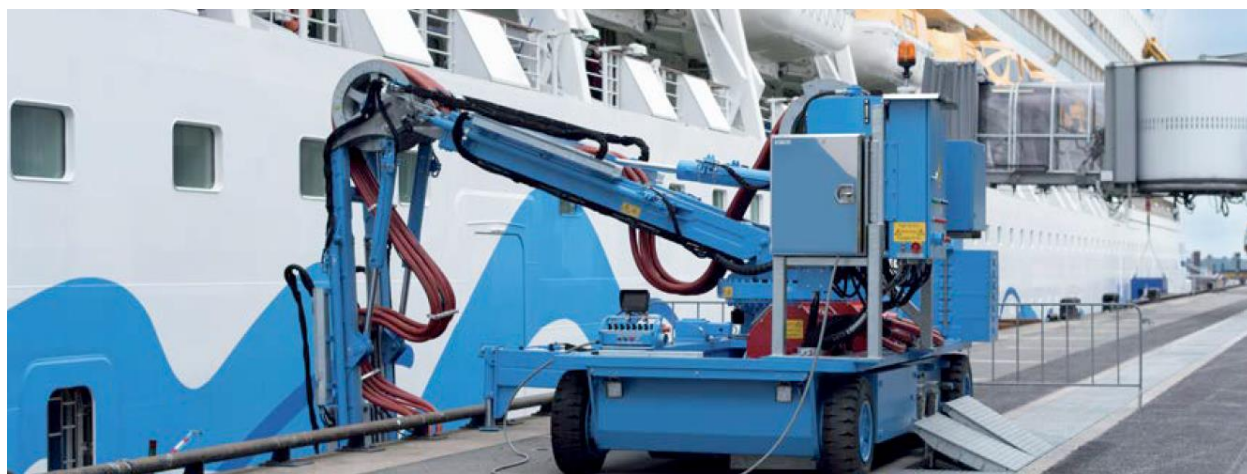
Slika 5.2 Pokretni kablenski kran [18]
