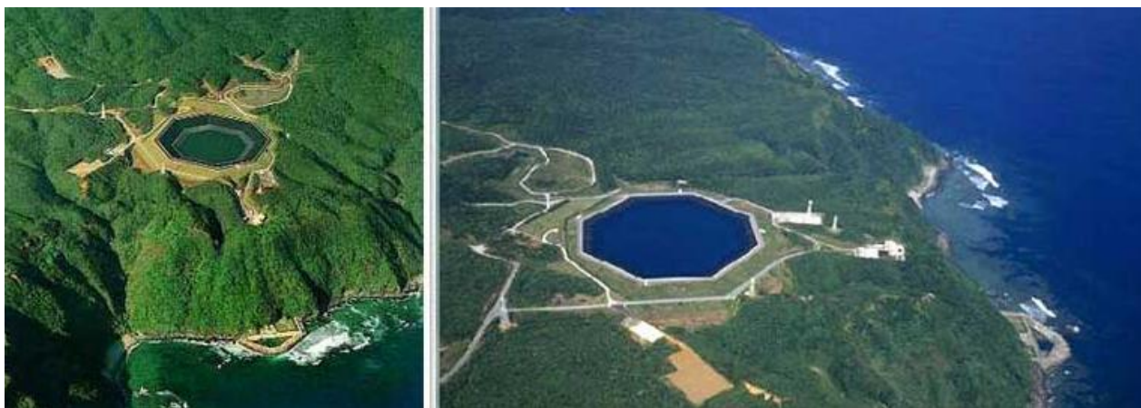
Slika 3.2. Prva crpno-akumulacijska hidroelektrana na morsku vodu - Okinawa Yanbaru (30MW) [15]
