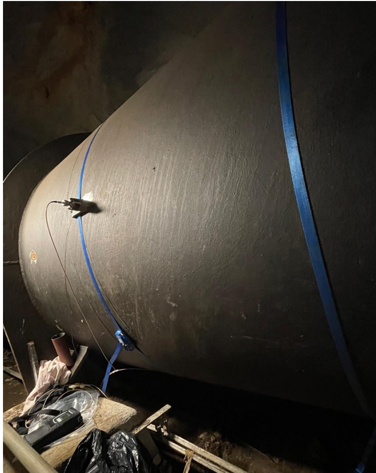
Slika 4.11. Montirani senzori ultrazvučnog mjerača na tlačnom cjevovodu HE Rijeka
