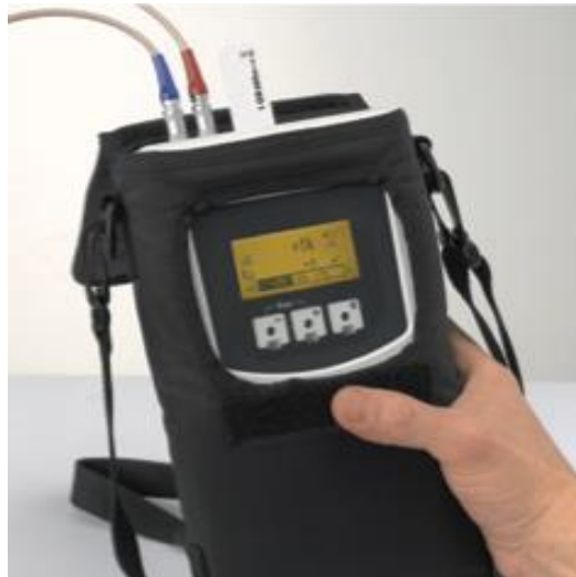
Slika 4.4. Putno računalo korištenog ultrazvučnog mjerača [9]
