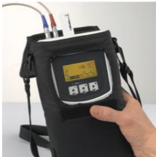
Slika 4.4. Putno računalo korištenog ultrazvučnog mjerača [9]
