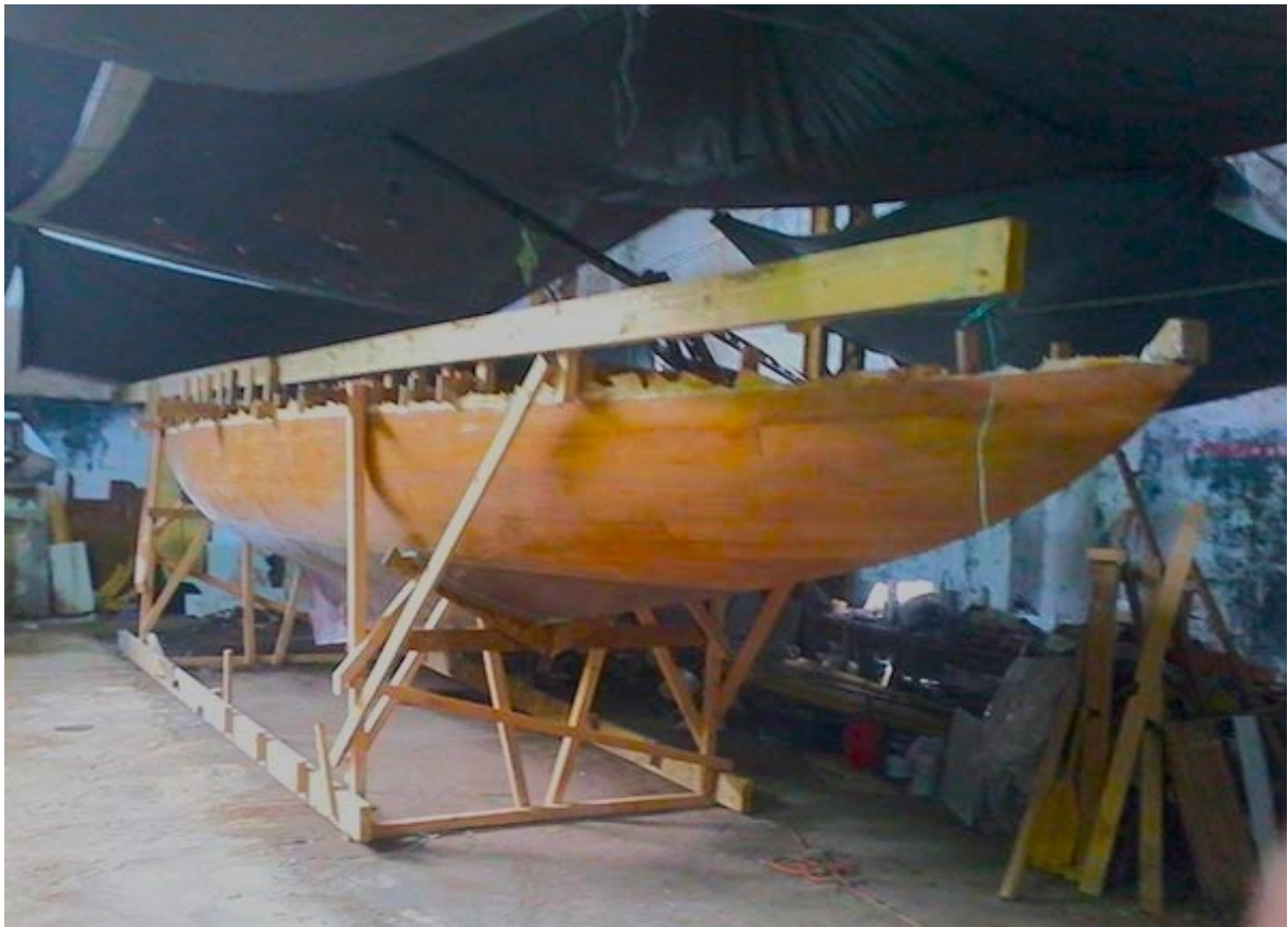
Slika 3.4. Jedrilica na okviru za okretanje [18]
