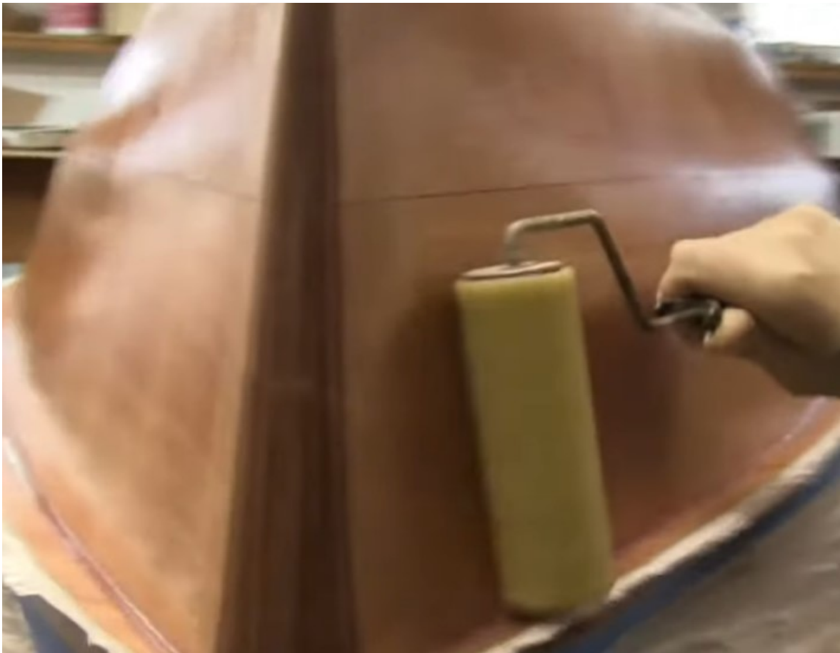
Slika 3.10. Prozirna i glatka površina završnog premaza [20]
