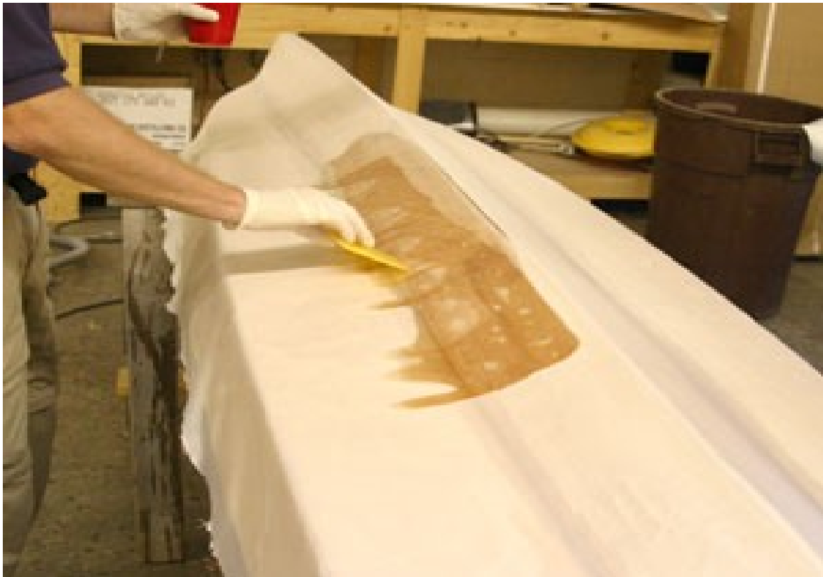
Slika 3.8. Raspršivanje epoksidne smjese po površini tkanine [19]
