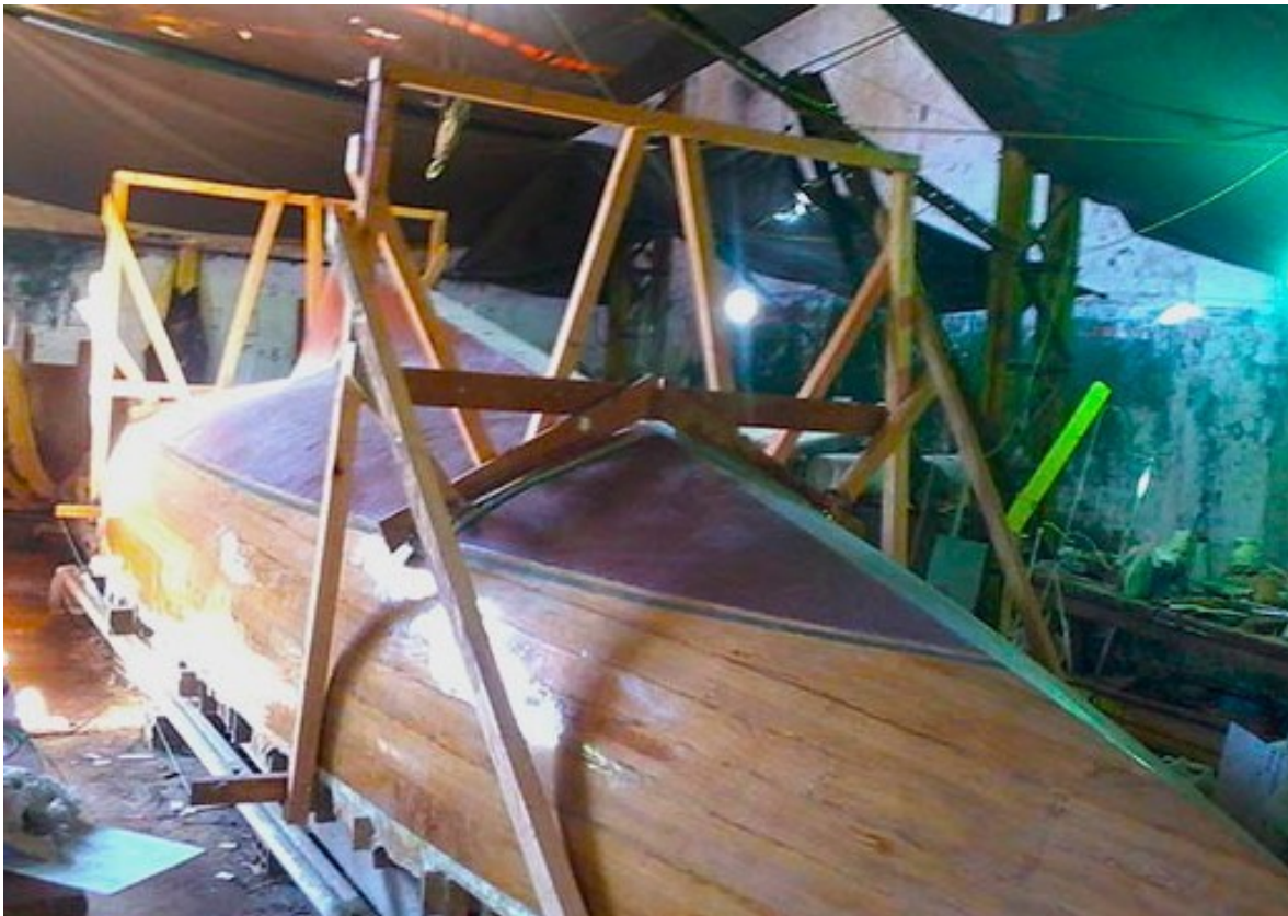
Slika 3.6. Jedrilica okrenuta naopačke [18]
