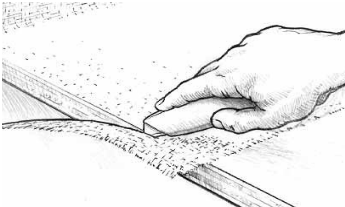
Slika 3.9. Ravnanje tkanine sa površinom vanjske oplata [9]
