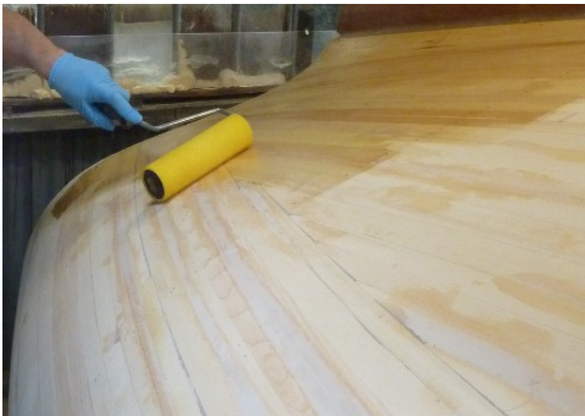
Slika 3.3. Zaštita vanjske oplata epoksidnom smolom [17]
