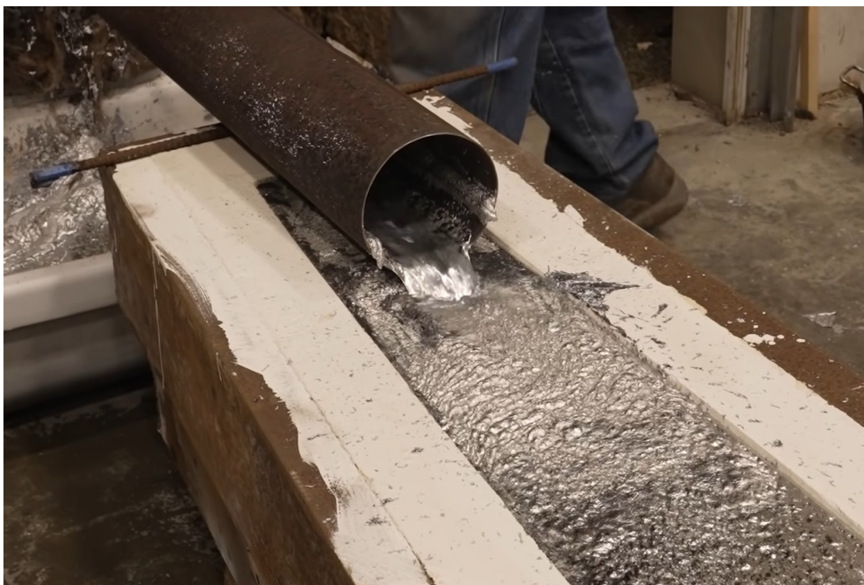
Slika 4.2. Izrada olovnog balasta [25]
