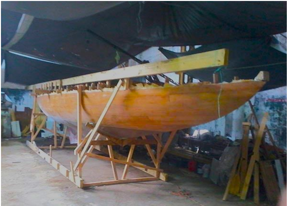
Slika 3.4. Jedrilica na okviru za okretanje [18]
