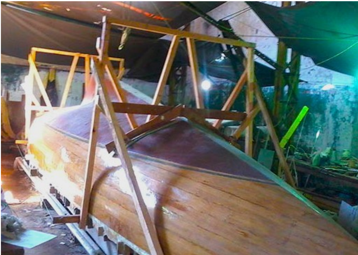
Slika 3.6. Jedrilica okrenuta naopačke [18]
