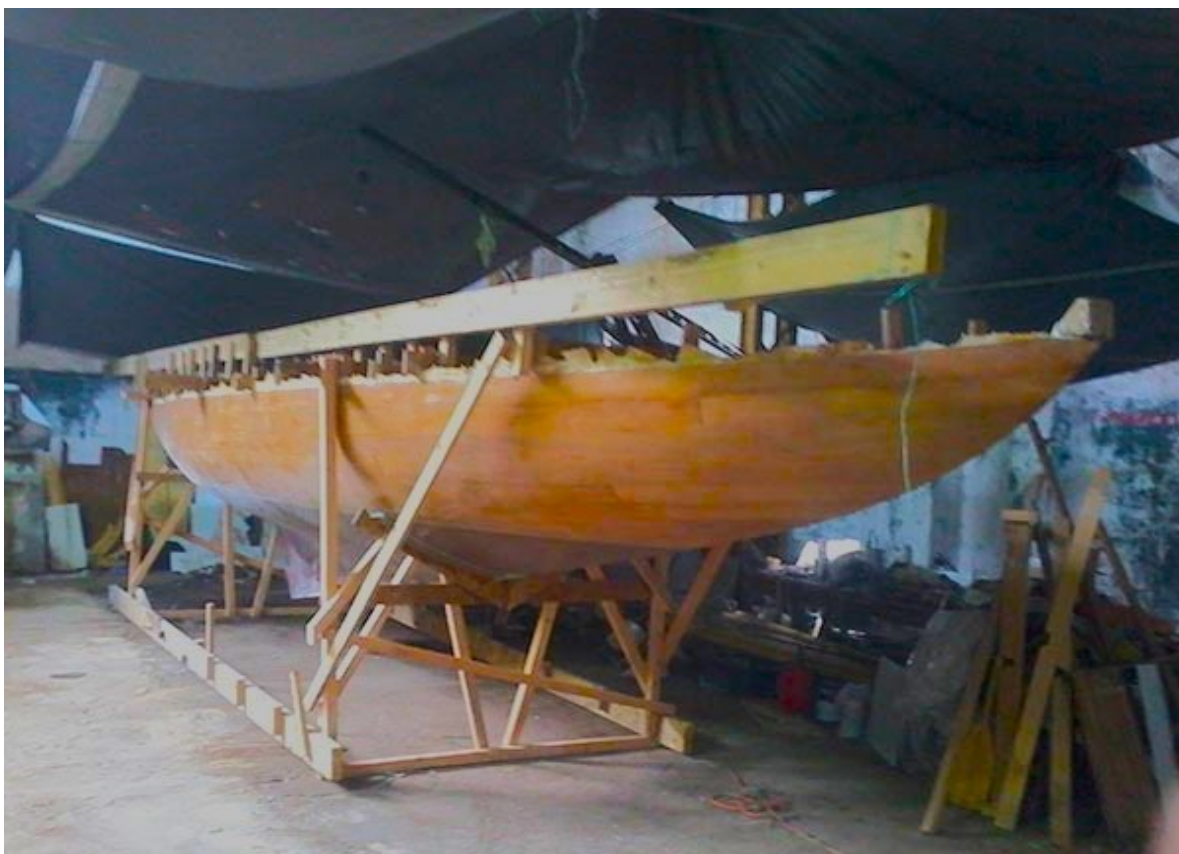
Slika 3.4. Jedrilica na okviru za okretanje [18]
