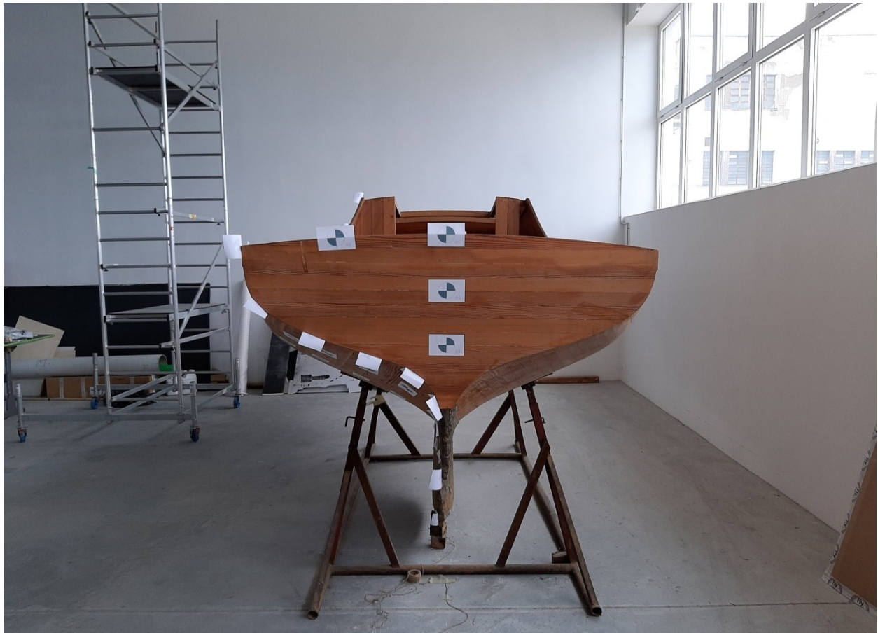
Slika 3.1. Vanjska oplata jedrilice – slikano u prostoru edukativne radionice „Torpedo“
