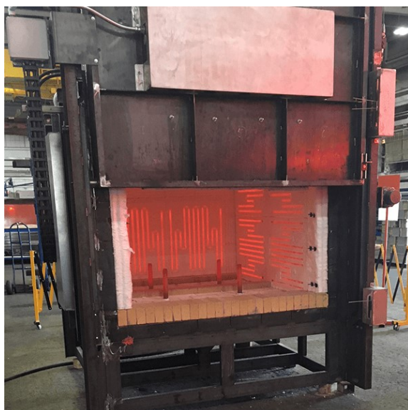
Slika 6.1. Peć u obliku kutije (eng. Box Furnace) [13]
