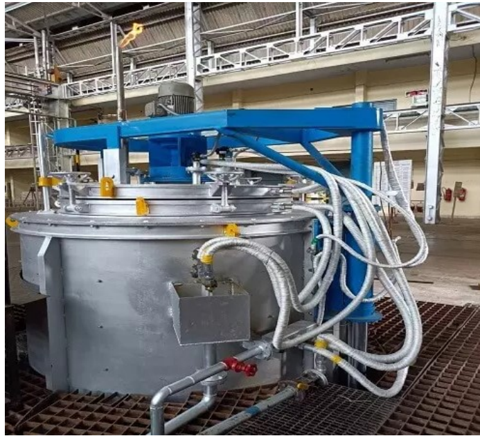
Slika 6.3. Cirkulacijska peć (eng. Pit Furnace) [15]
