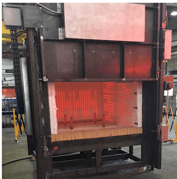
Slika 6.1. Peć u obliku kutije (eng. Box Furnace) [13]
