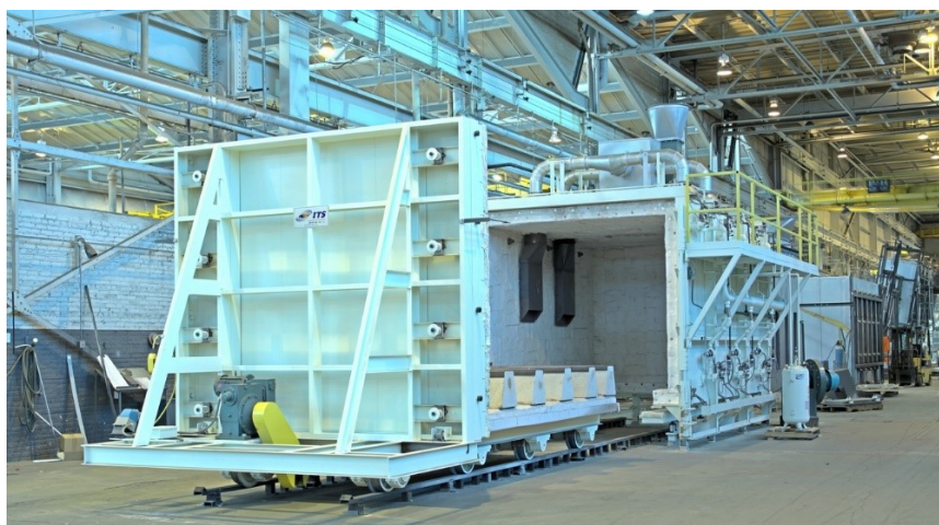
Slika 6.4. Peć sa pomičnim dnom (eng. Car Bottom Furnace) [16]
