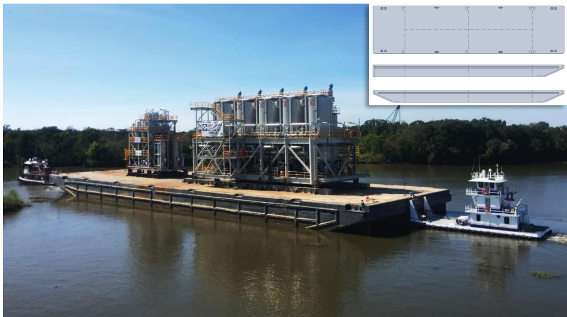
Slika 2.4. Deck barge – teretna barža [3].
