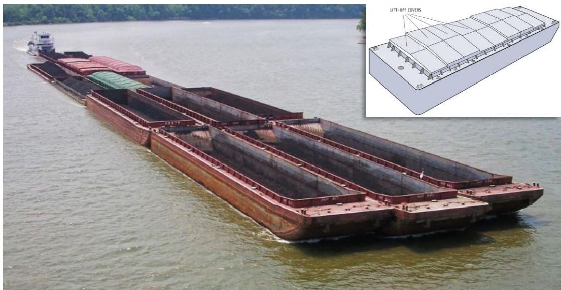
Slika 2.6. Hopper barges – barža za rasuti teret [3].
