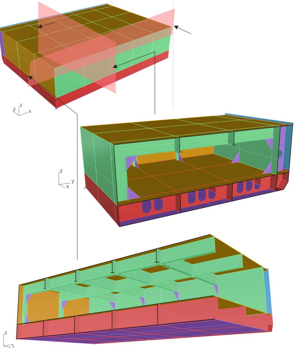
*Slika 4.14. Primarna struktura – Parcijalni geometrijski model.*
