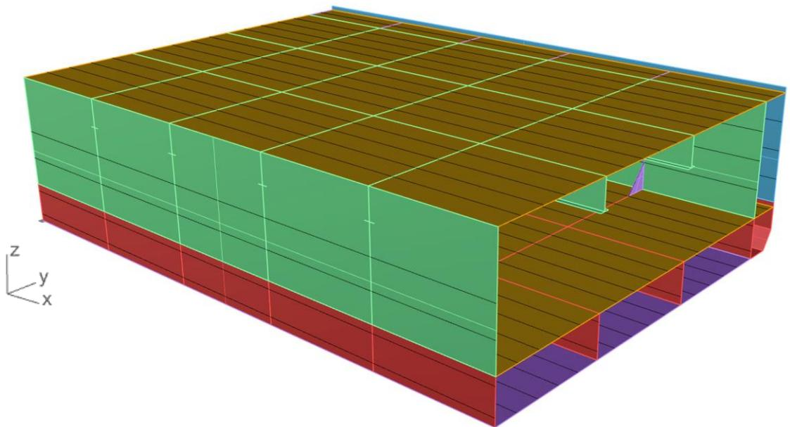
*Slika 4.15. Primarna i sekundarna struktura – Parcijalni geometrijski model.*
