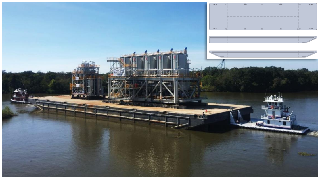
Slika 2.4. Deck barge – teretna barža [3].
