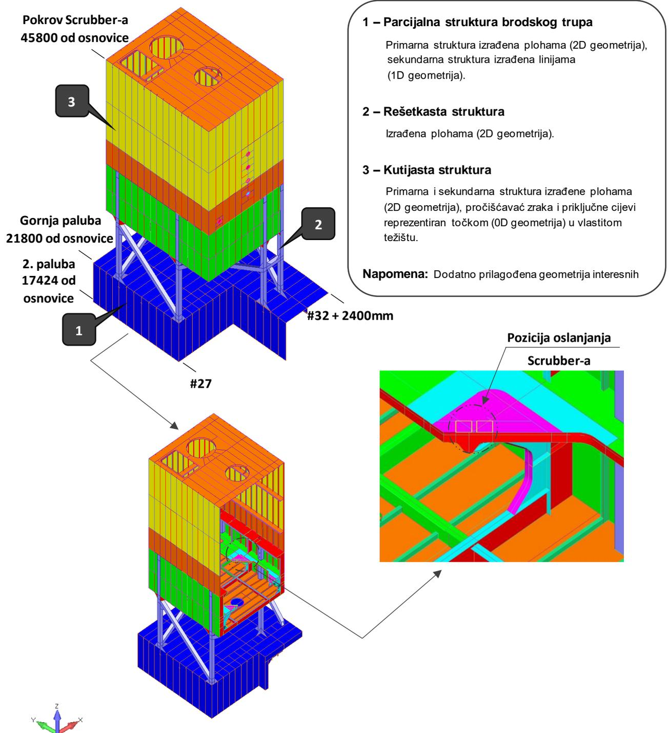
Slika 4.5. Primjer pripremljene geometrije za FEA [4].
