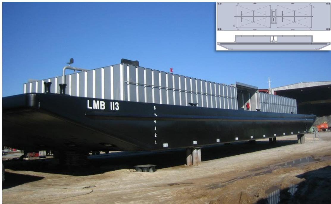
*Slika 2.8. Liquid mud barges – barža za transport otpadnih tekućina sa naftnih bušotina [3].*
