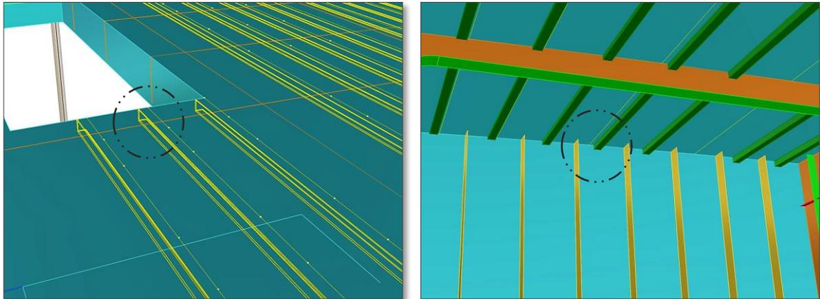
Slika 4.11. Greške geometrijskog modela – Ne poklapanje strukture [4].
