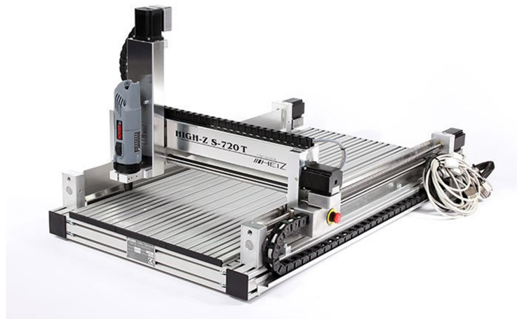
Slika 6.1 CNC glodalica Step High Z [9]
