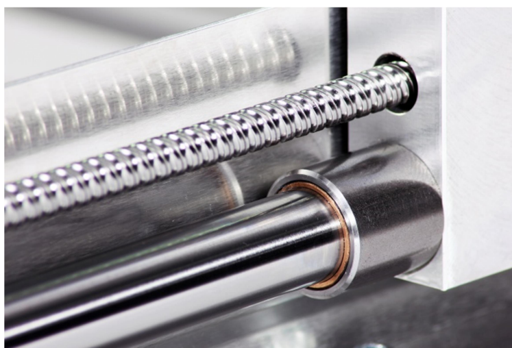
Slika 6.2 Prikaz vodilica za x os laboratorijske CNC glodalice [9]
