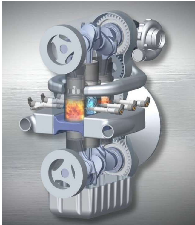
Slika 3.2 Pojednostavljeni prikaz Achatesa motora s nasuprotnim klipovima [6]
