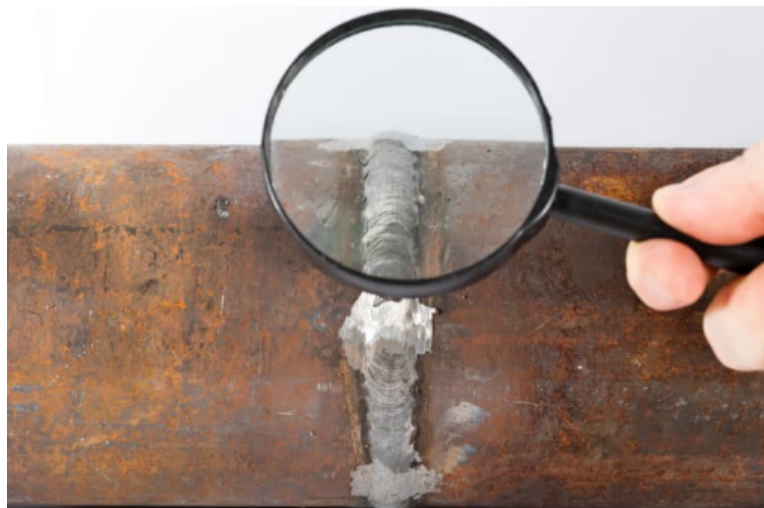
Slika 2.1. Vizualni pregled zavara pomoću povećala [1]
