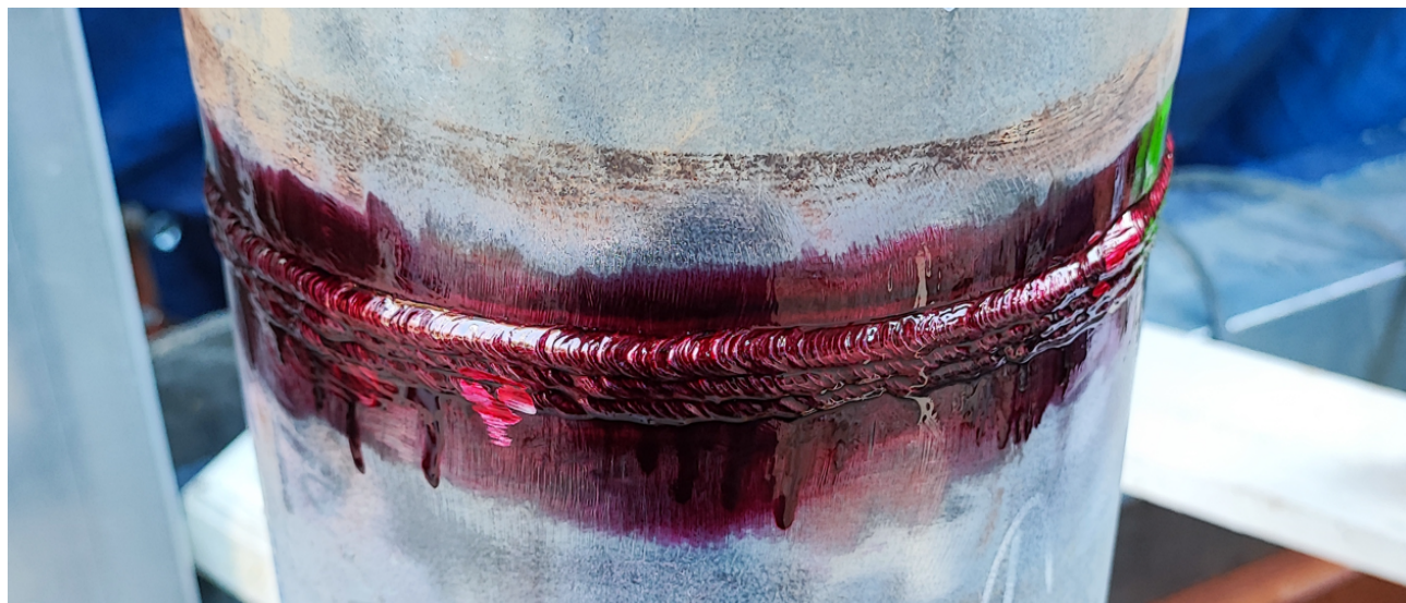
Slika 5.4. Prikaz nanesenog crvenog penetranta na zavar
