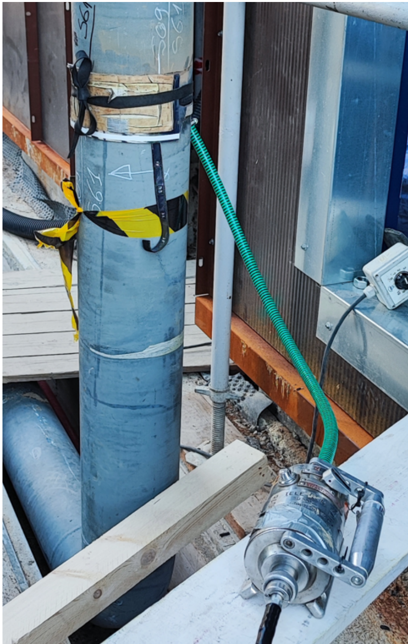
Slika 4.18. Vodilica sa kolimatorom prislonjenim uz zavar
