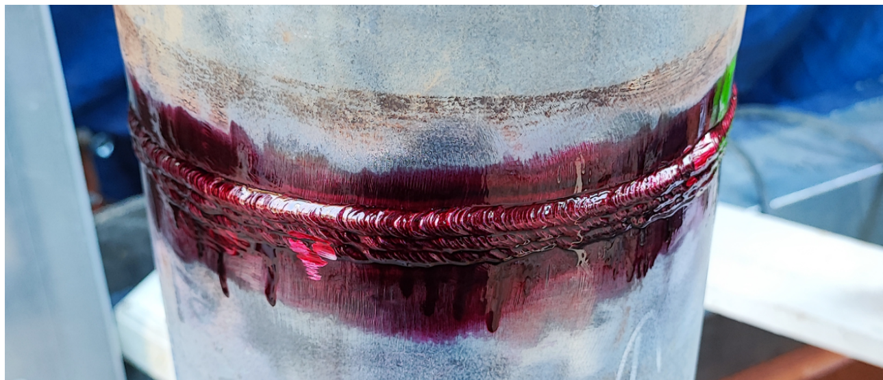
Slika 5.4. Prikaz nanesenog crvenog penetranta na zavar
