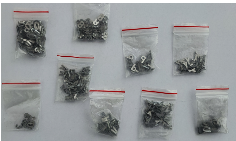
Slika 4.10. Olovna slova i brojevi za označavanje zavora
