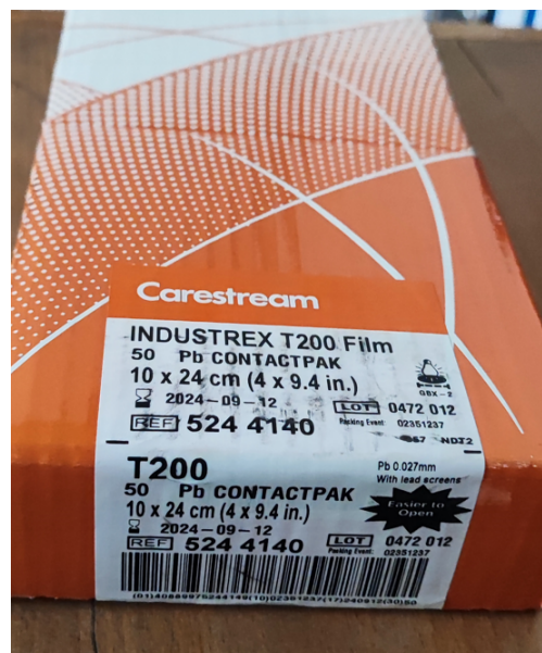
Slika 4.8. Kutija sa radiogramima gdje je prikazan broj šarže i rok valjanosti
