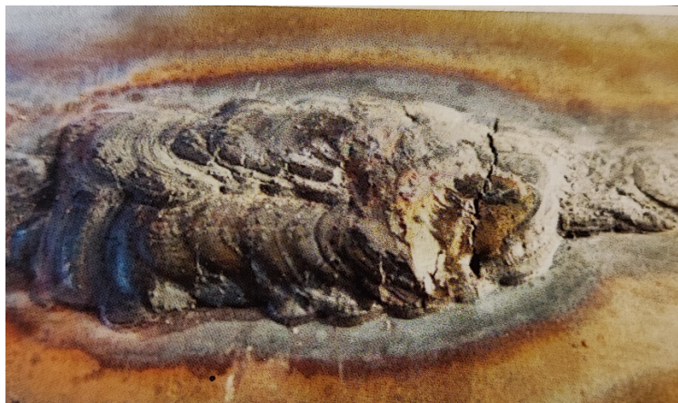
Slika 3.4. Poprečna pukotina u krateru koja se proteže u ZUT [5]
