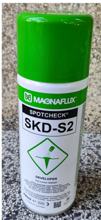
Slika 5.3. Razvijač oznake SKD-S2 korišten za ispitivanje
