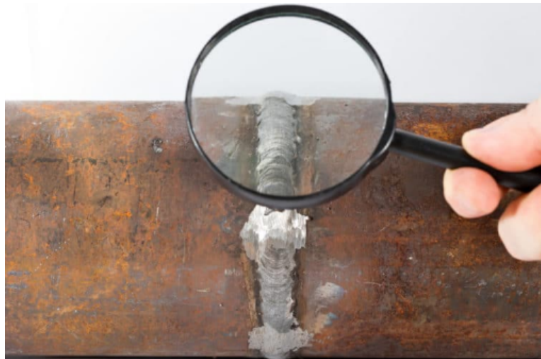
Slika 2.1. Vizualni pregled zavara pomoću povećala [1]
