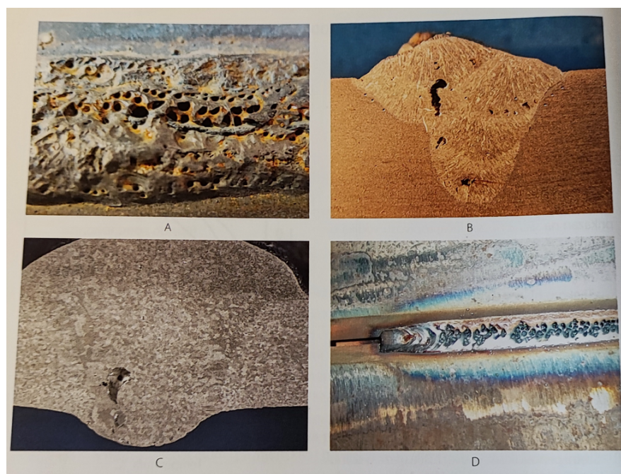
Slika 3.8. Primjeri poroznosti u zavarenom spoju [5]; A- površinska poroznost pri EPP zavarivanju čelika; B – poroznost pri REL zavarivanju Cr-Ni čelika; C- pore pri TIG zavarivanju aluminija; D – pore u korijenu kod MAG zavarivanja čelika
