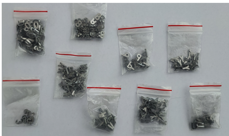
Slika 4.10. Olovna slova i brojevi za označavanje zavora
