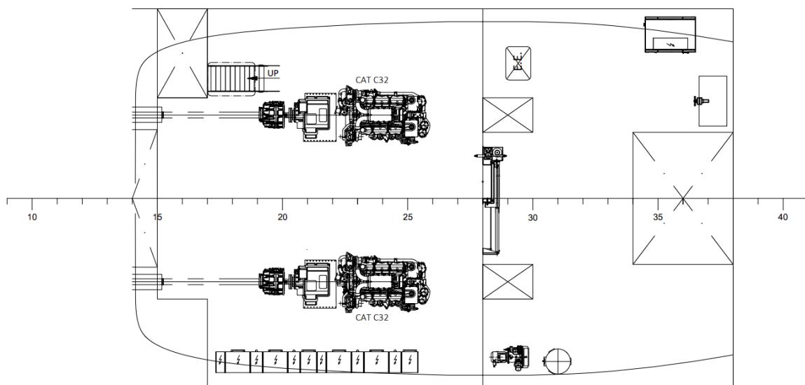
Slika 5.2 Tlocrt strojarnice predmetnog broda
