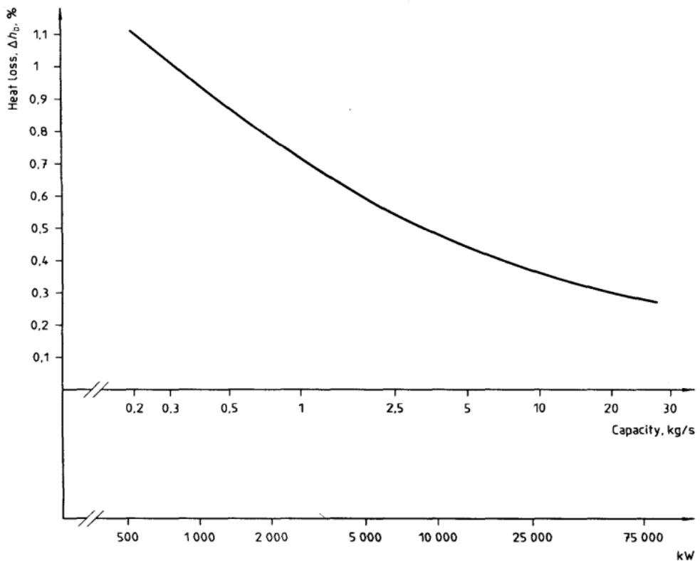
Slika 2.3 Dijagram za određivanje gubitaka topline kotlova [1]
