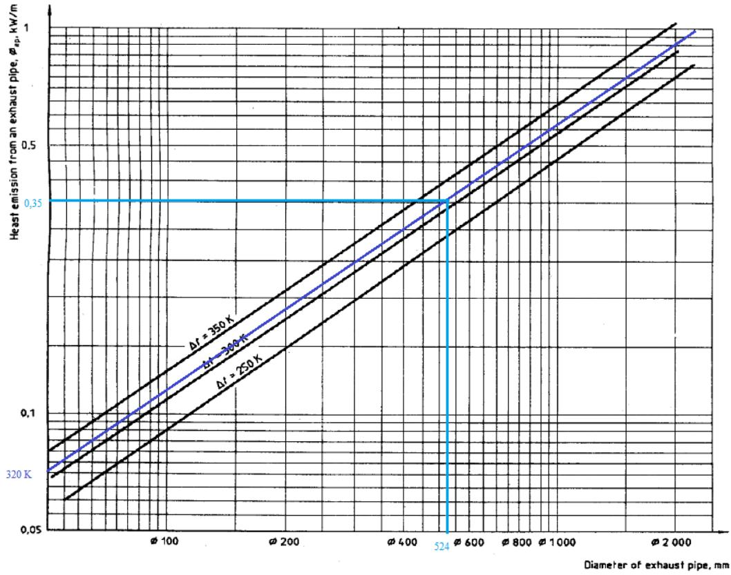
Slika 5.4 Specifične emisije topline cijevi ispušnih plinova [1]
