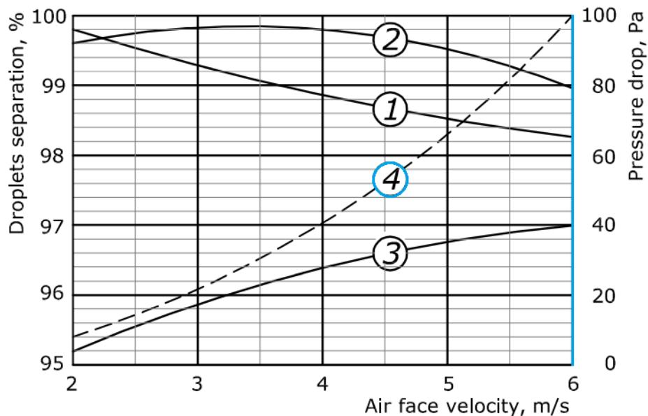
Slika 7.1 Dijagram za određivanje pada tlaka na usisnoj rešetci [5]
