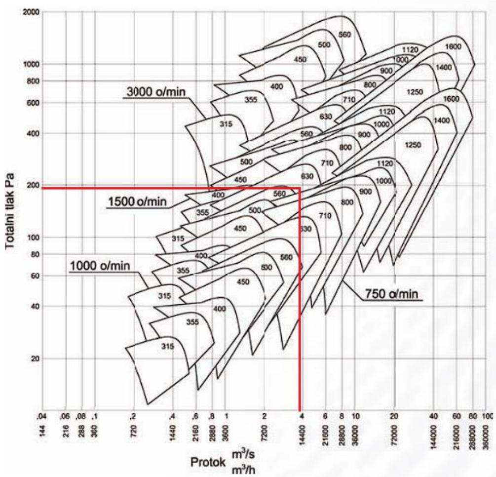
Slika 7.5 Radno područje aksijalnih ventilatora – usis svježeg zraka [6]
