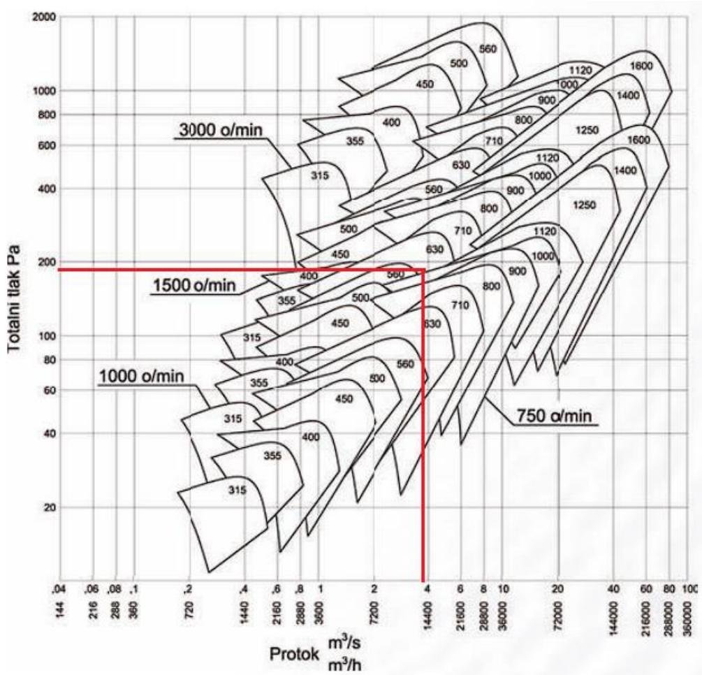
Slika 7.7 Radno područje aksijalnih ventilatora – ispuh otpadnog zraka [6]
