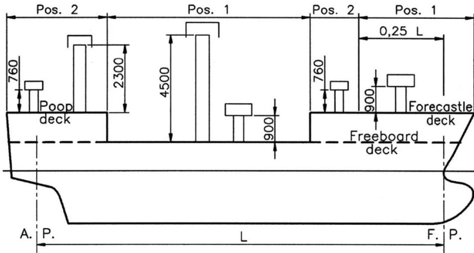
Slika 4.2 Zahtijevane visine ventilacijskih rešetki [7]
