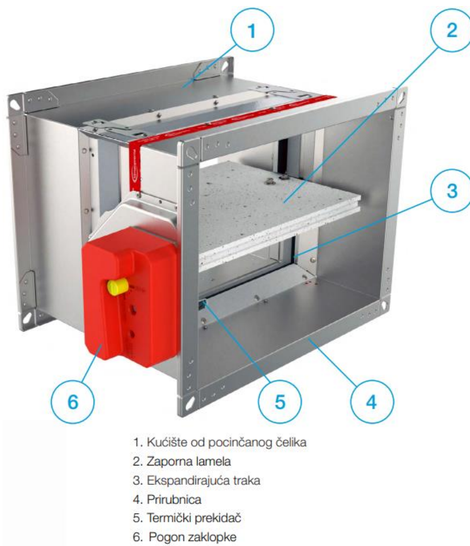
Slika 7.4 Protupožarna zaklopka u usisnom kanalu [14]
