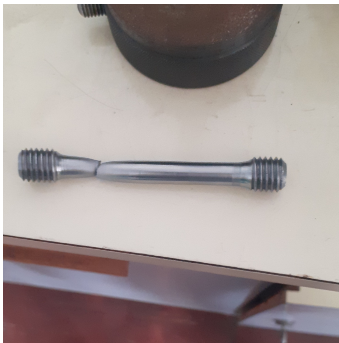
Slika 7.10. Testna epruveta 1 nakon testa vlačne čvrstoće
