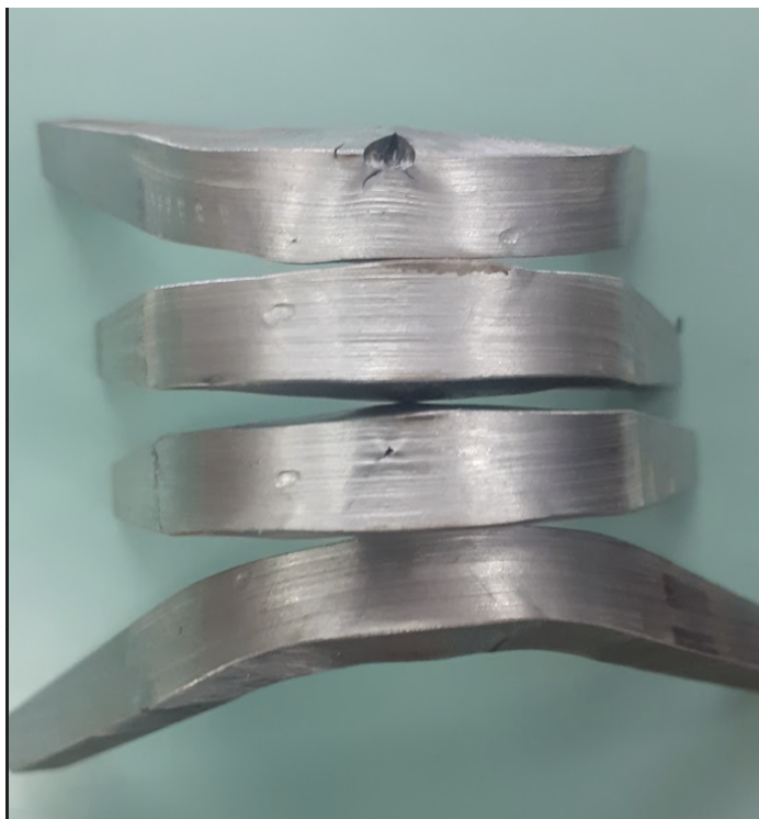
Slika 7.7. Savijeni uzorci su nemaju većih pukotina u usporedbi sa napuknutim primjerom uzorka sa drugog zavara
