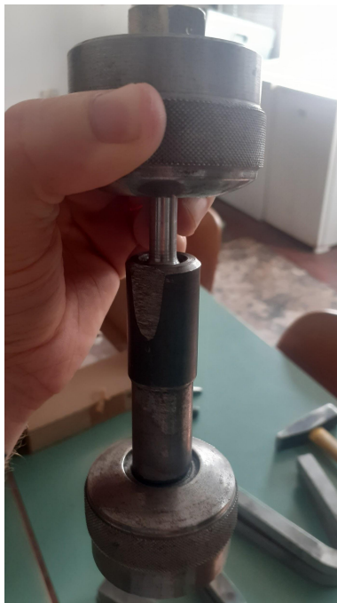
Slika 7.8. Polaganje testne epruvete u prstene od kidalice
