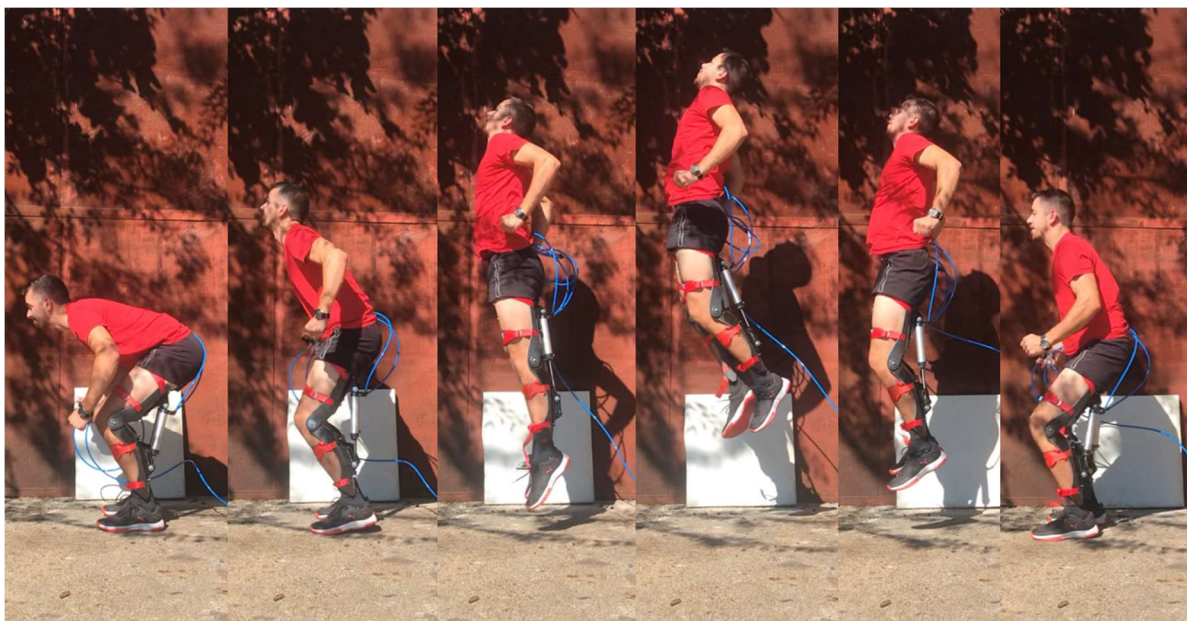
Slika 6.27. Faze skoka pri eksperimentalnom testiranju egzoskeleta
