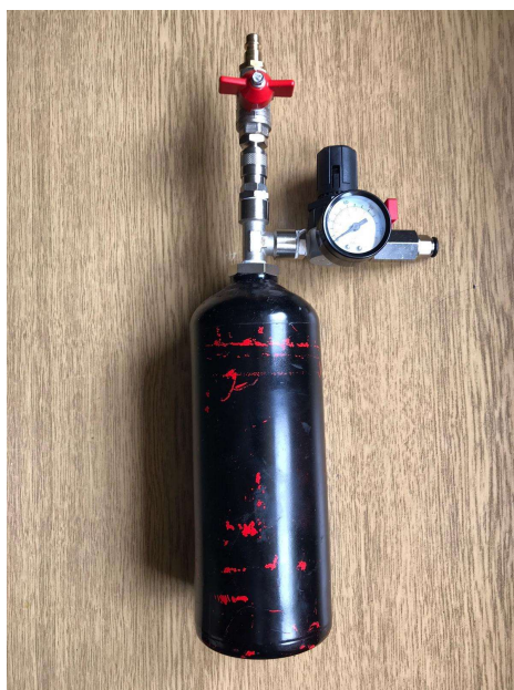
Slika 6.22. Tlačni spremni sa svim montiranim komponentama
