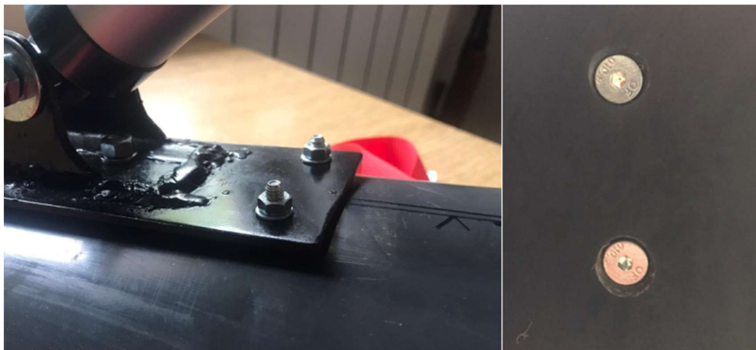
Slika 6.19. Povezivanje prihvata cilindra na bedreni prihvat
