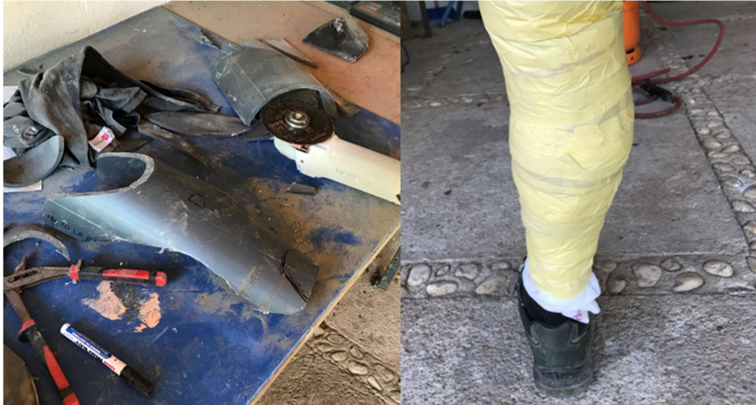
Slika 6.16. Grubo obrađena cijev (lijevo) i izolirana noga korisnika (desno)
