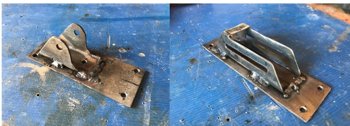
Slika 6.18. Prihvat cilindra (lijevo) i prihvat klipnjače (desno)
