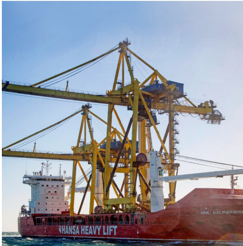
Slika 2.10. Teret velikih dimenzija – dizalice
