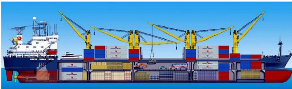
Slika 2.1. Presjek teretnog prostora broda za prijevoz općeg tereta
