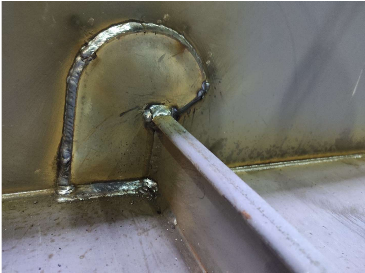
Slika 4.4.1.2 Nepropusni kutni spoj [7]
