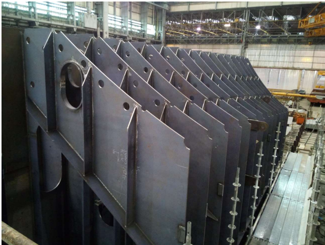
Slika 5.1.1.3 Spoj rebra na oplatu
