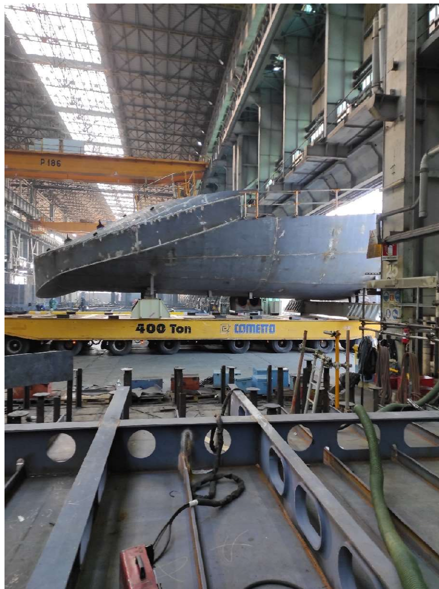
Slika 4.6.4 Limovi oplata krmene sekcije
