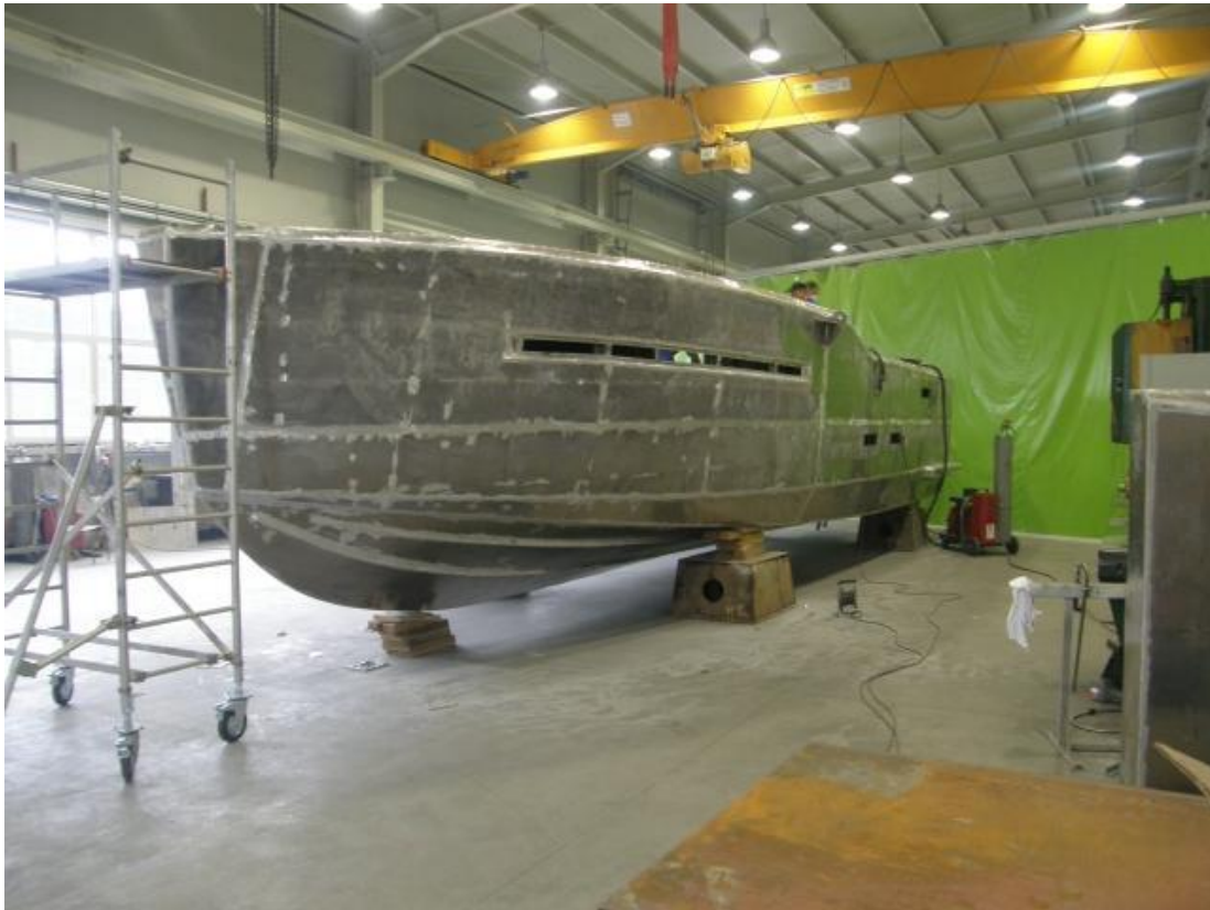
Slika 4.5.1 Trup aluminijskog plovila
