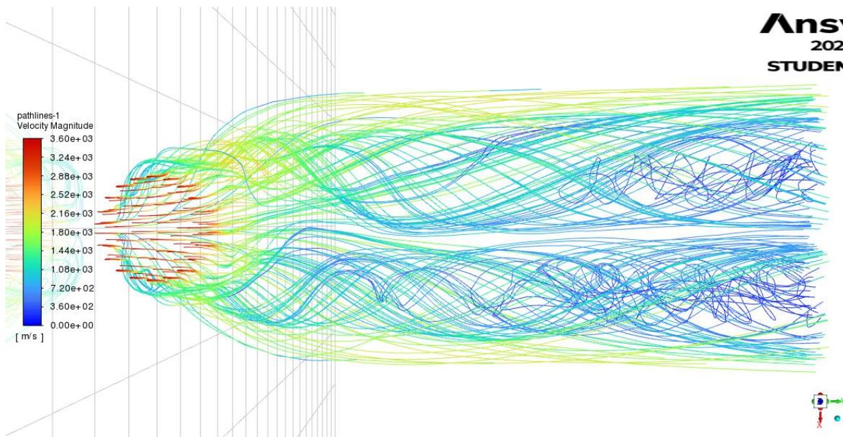
Slika 6.11. Tlocrt kontura strujanja za  $\dot{V}_1$
