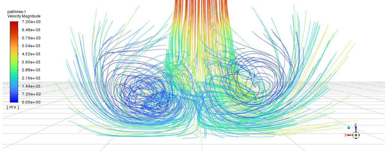
Slika 6.16. Bokocrt kontura strujanja za  $\dot{V}_2$
