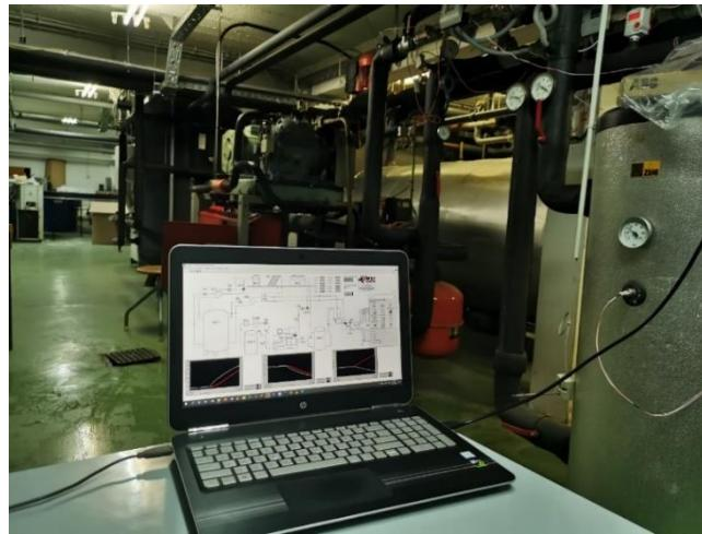
Slika 5.9 Računalo povezano sa sustavima za akviziciju korišteno za praćenje i pohranjivanje mjereneh temperatura i protoka vode i temperaturna parafina
