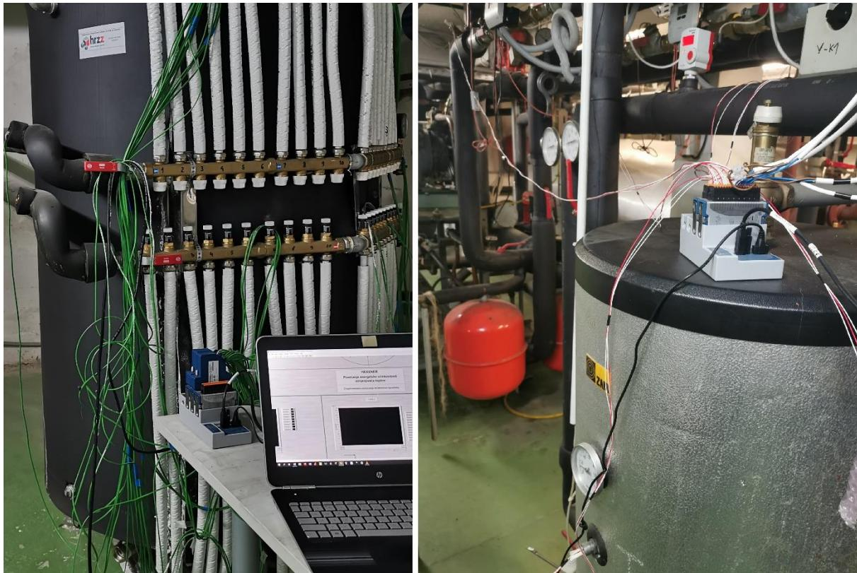
Slika 5.8 Modularni sustavi za akviziciju mjerjenih temperatura i protoka radnih medija
