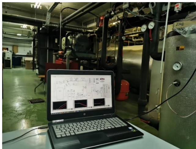
Slika 5.9 Računalo povezano sa sustavima za akviziciju korišteno za praćenje i pohranjivanje mjerenih temperatura i protoka vode i temperatura parafina
