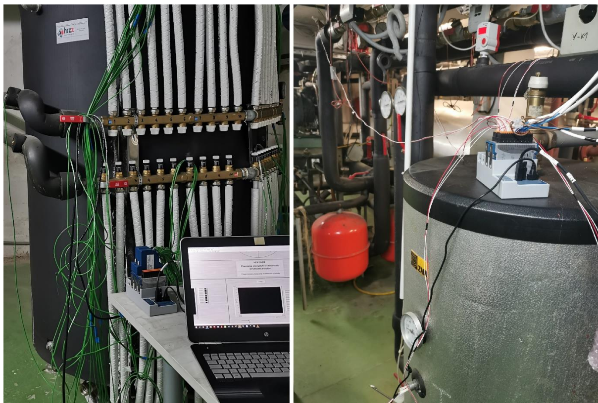
Slika 5.8 Modularni sustavi za akviziciju mjerenih temperatura i protoka radnih medija
