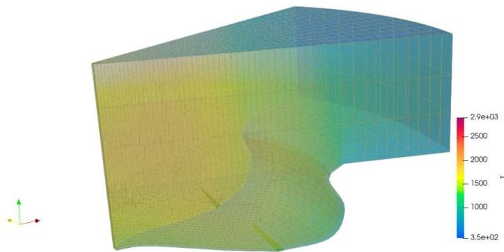
Slika 8.6. Temperatura za kut KV  $40^\circ$
