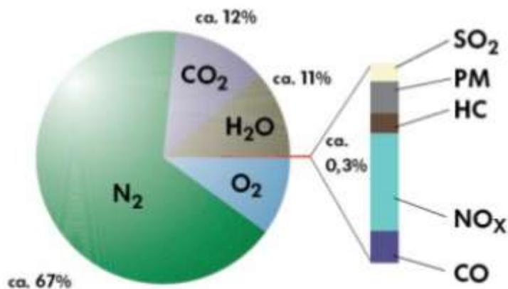
Slika 4.1. Sastav ispušnih plinova Dieselovog motora [1]
