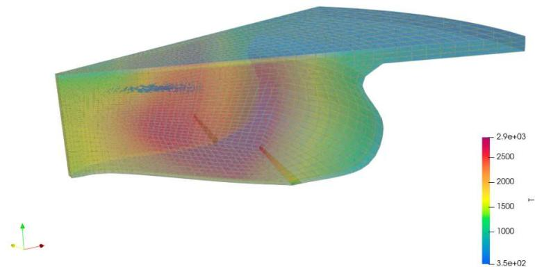
*Slika 8.4. Maksimalna temperatura procesa za kut KV  $6^\circ$*
