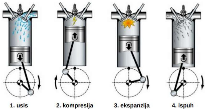
Slika 1.1. Četiri takta motora [1]
