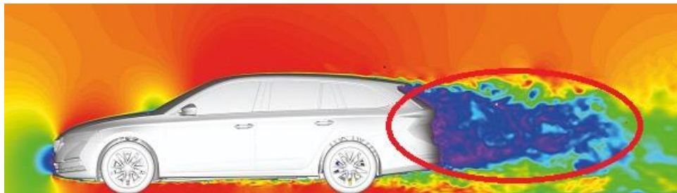
Slika 0.6 Područje odstrujavanje kod automobila [12]
