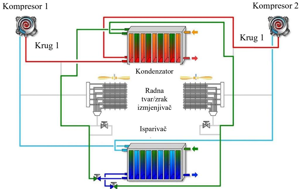
*Slika 7.3. Shematski prikaz spajanja elemenata unutar dizalice topline*
