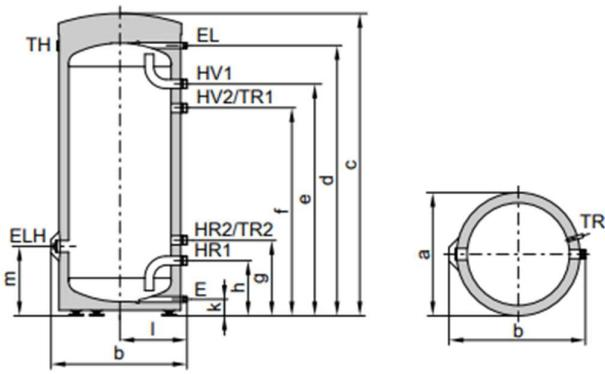
Slika 7.6. Nacrt inercijskog spremnika Vitocell 100-E/-W 200
