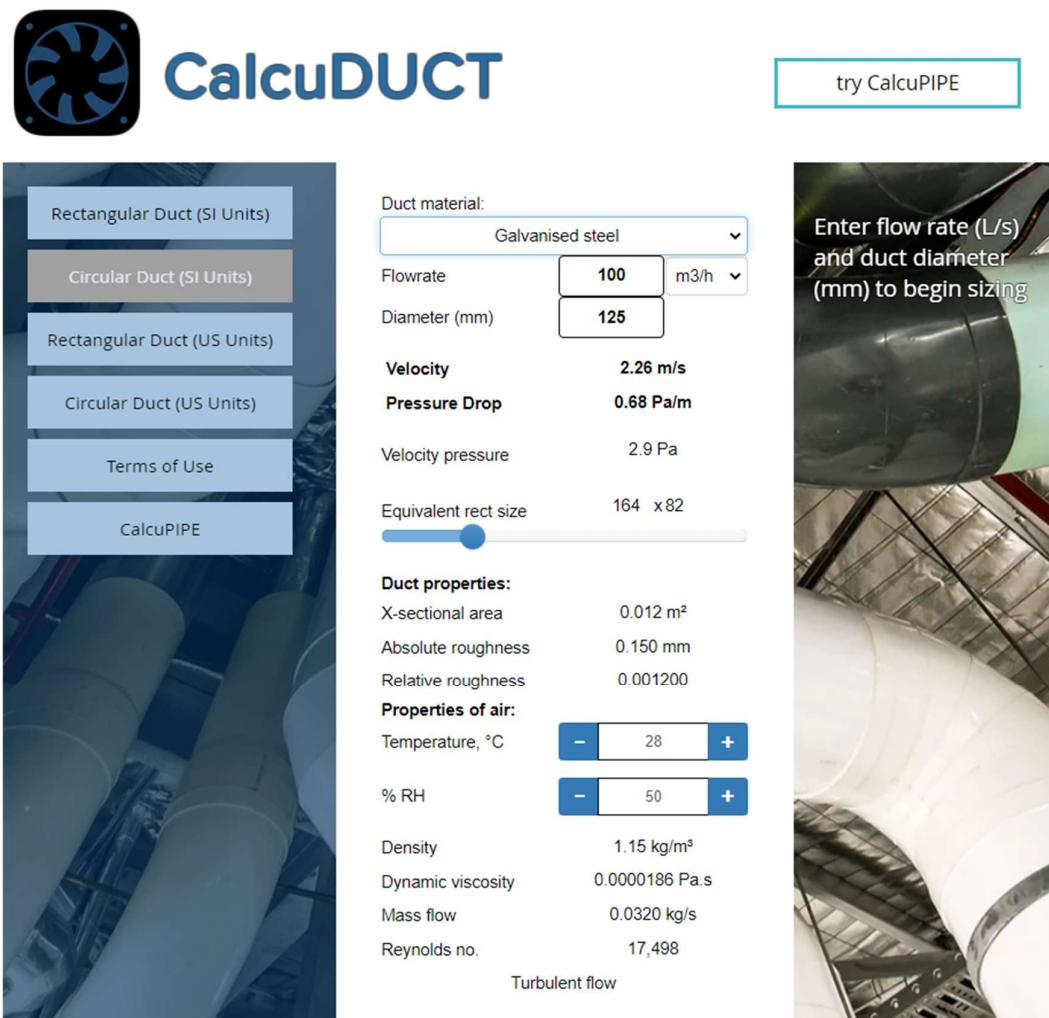
*Slika 4.7. Kalkulator pada tlaka u ventilacijskim kanalima [10]*
