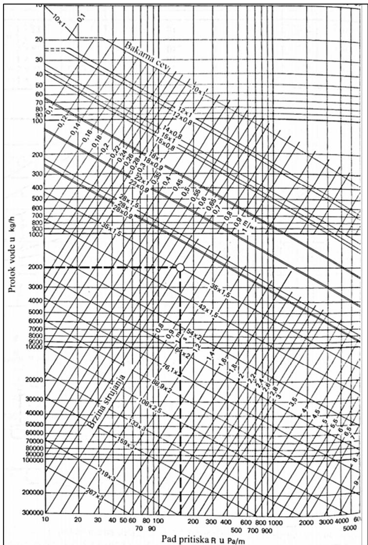
Slika 8.1. Graf pada tlaka u toplovodnim okruglim cijevima [7]
