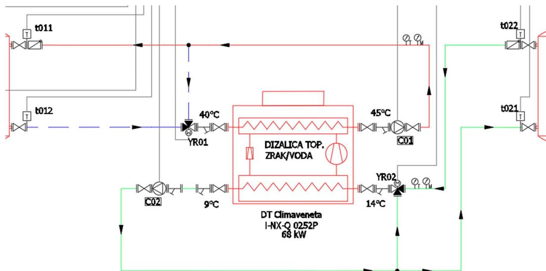
Slika 9.4. Shematski prikaz dijela cjevovoda uz dizalicu topline
