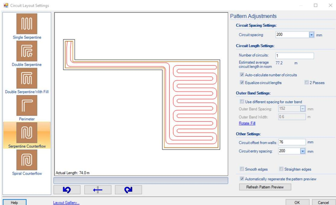
Slika 5.2. Automatski generirana protustrujna (engl. Counterflow) petlja blagovaone
