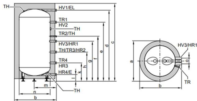
Slika 7.4. Nacrt inercijskog spremnika Vitocell 100-E 950
