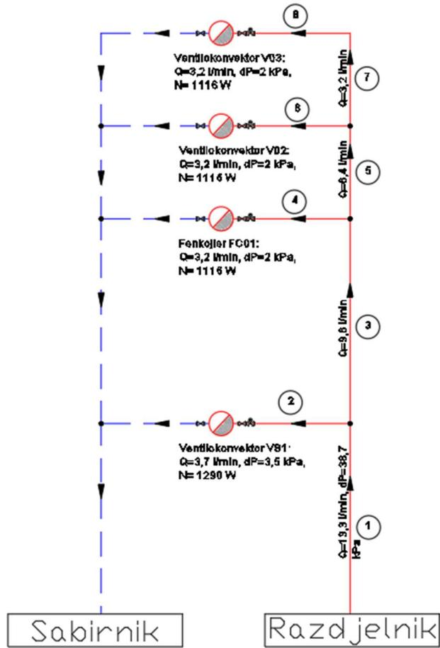
Slika 9.2. Shematski prikaz spajanja cjevovoda za napajanje ventilokonvektora
